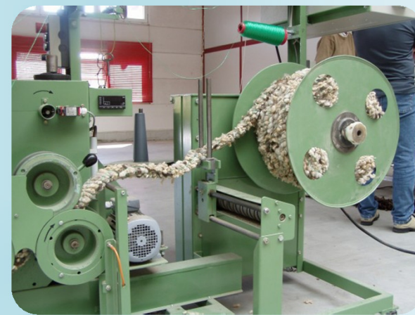
Macchina per il confezionamento delle funi utilizzate per stabilizzare le scarpate legandole alle reti
