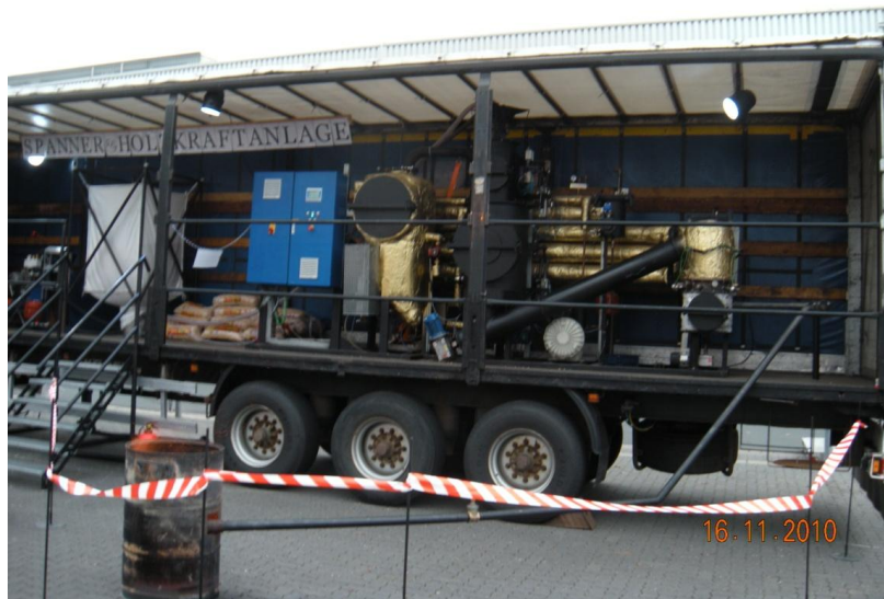
Figura 1 – Pirogassificatore a pellet e cippato per alimentazione motore da 30 kWe -
