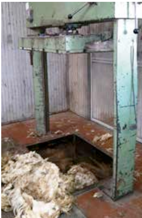
La lana cernita è pressata mediante presse a buca in balle da immagazzinare in attesa del lavaggio
