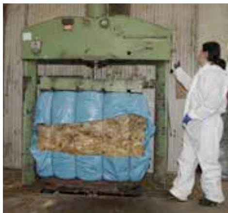
Completamento dell'operazione di pressatura pre-lavaggio
