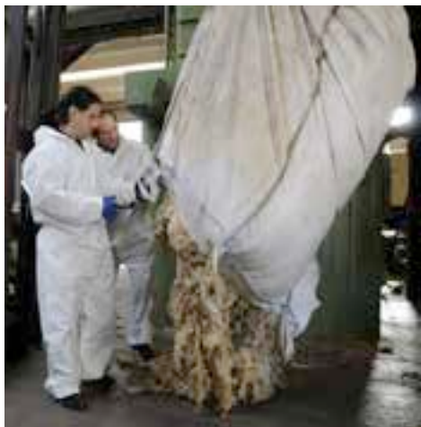
I sacchi non adatti spesso si spanciano durante la presa con i muletti usati per la movimentazione presso le aziende di lavaggio
