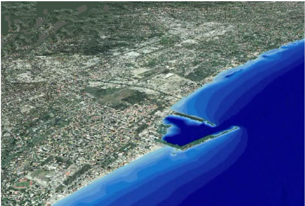
Figura 1 - Batimetria 3d dell'area portuale di Marina di Carrara: i cambiamenti di intensità di colore corrispondono ad intervalli di 1 m di profondità.
