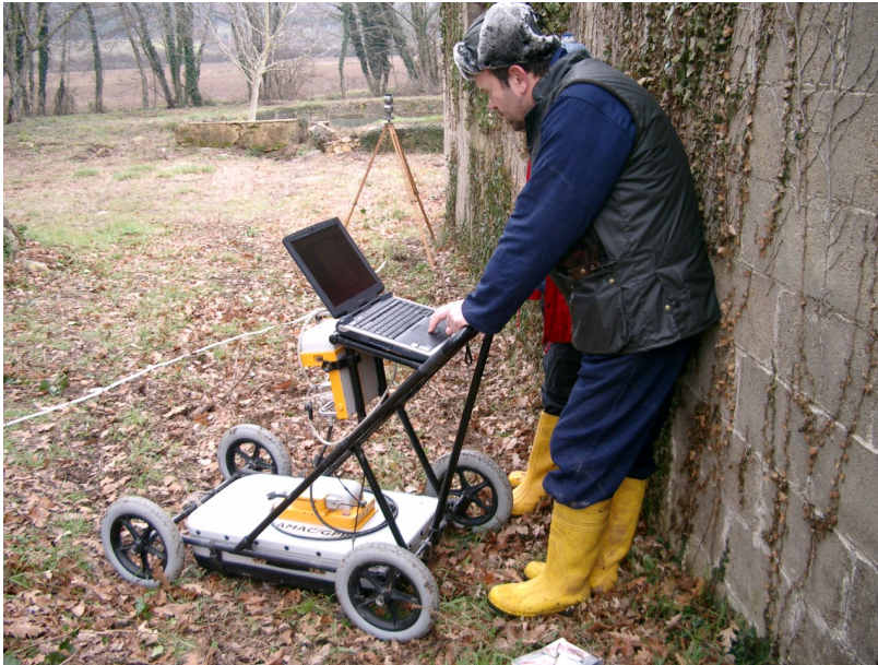
Figura 4 – Acquisizione di un profilo georadar. Figure 4 – Georadar profile acquisition.
