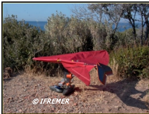
Figura 5 – Miniaerei telecomandati utilizzati per la fotografia aerea. Miniairplane operate by remote control used for the air photograph.
