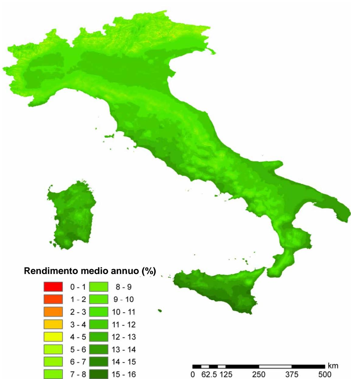
Figura 2.A2.33: Rendimento economico medio annuo di sistemi fotovoltaici da 10 kWh di potenza di picco su superficie inclinata di 35° verso sud: ipotesi di un completo utilizzo dell'energia elettrica prodotta
