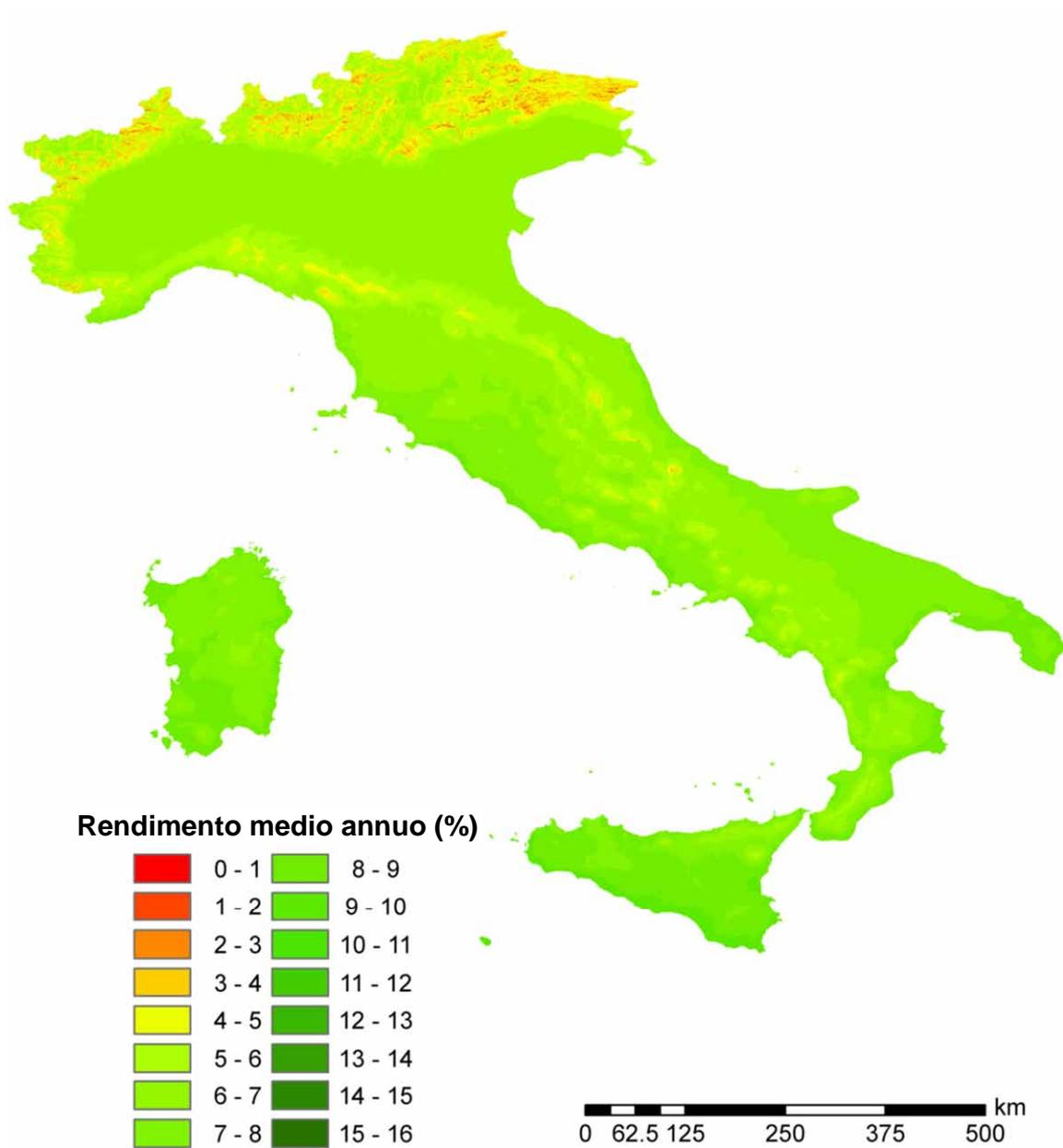
Figura 2.A2.46: Rendimento economico medio annuo di sistemi fotovoltaici da 15 kWh di potenza di picco su superficie inclinata di 32.5° verso sud: ipotesi di utilizzo dell'energia elettrica prodotta per 5000 kWh.
