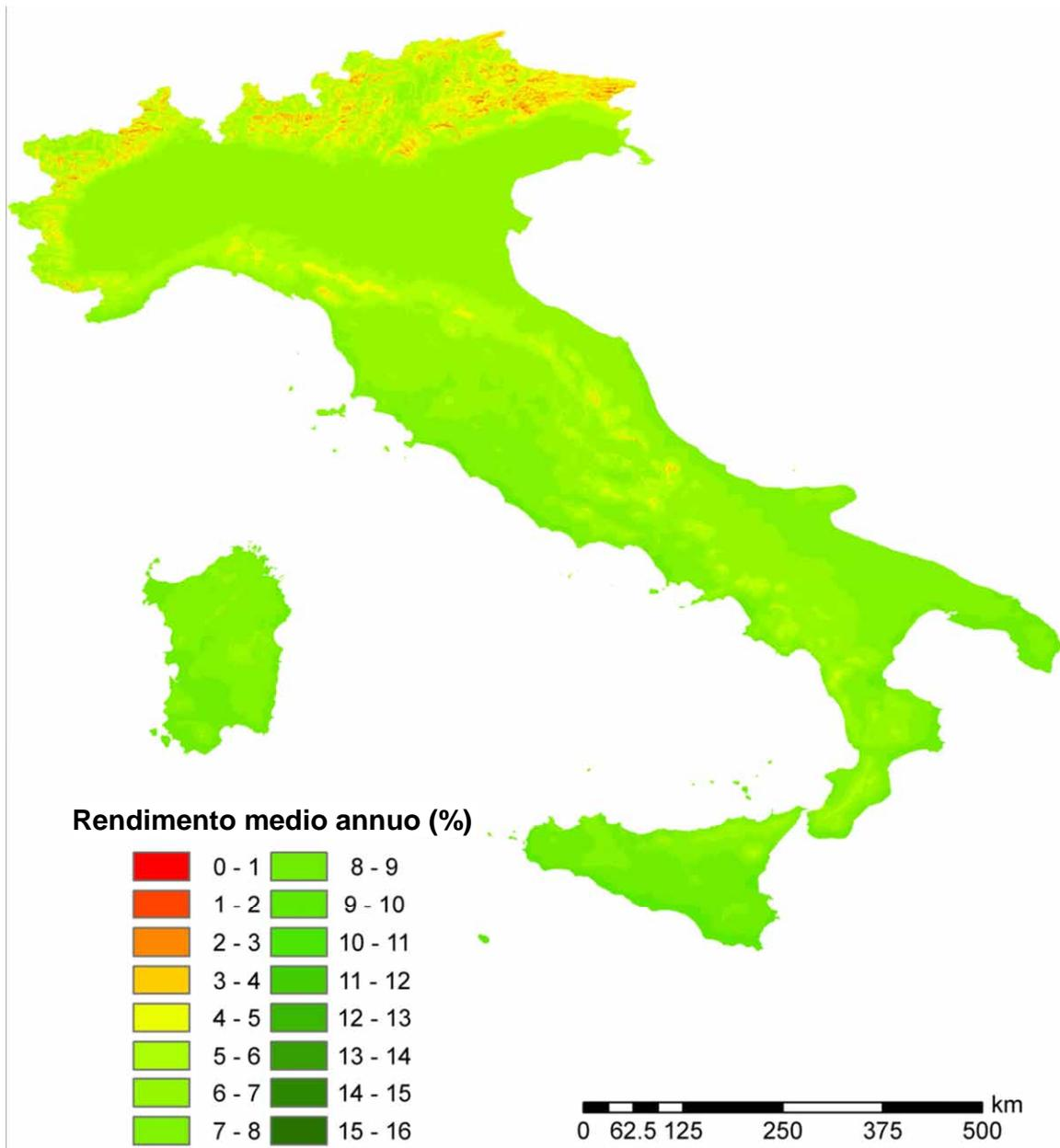
Figura 2.A2.47: Rendimento economico medio annuo di sistemi fotovoltaici da 15 kWh di potenza di picco su superficie inclinata di 35° verso sud: ipotesi di utilizzo dell'energia elettrica prodotta per 5000 kWh.
