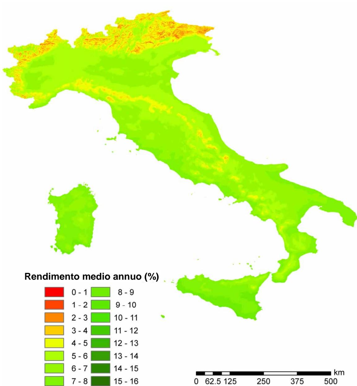
Figura 2.A2.19: Rendimento economico medio annuo di sistemi fotovoltaici da 10 kWh di potenza di picco su superficie inclinata di 35° verso sud: ipotesi di utilizzo dell'energia elettrica prodotta per 2300 kWh.
