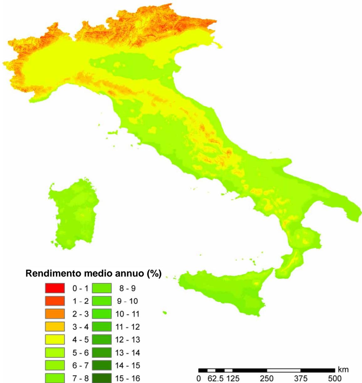
Figura 2.A2.15: Rendimento economico medio annuo di sistemi fotovoltaici da 10 kWh di potenza di picco su superficie orizzontale: ipotesi di utilizzo dell'energia elettrica prodotta per 2300 kWh.
