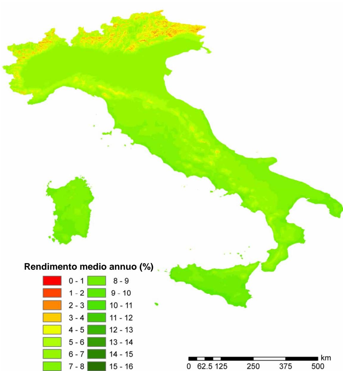
Figura 2.A2.45: Rendimento economico medio annuo di sistemi fotovoltaici da 15 kWh di potenza di picco su superficie inclinata di 30° verso sud: ipotesi di utilizzo dell'energia elettrica prodotta per 5000 kWh.
