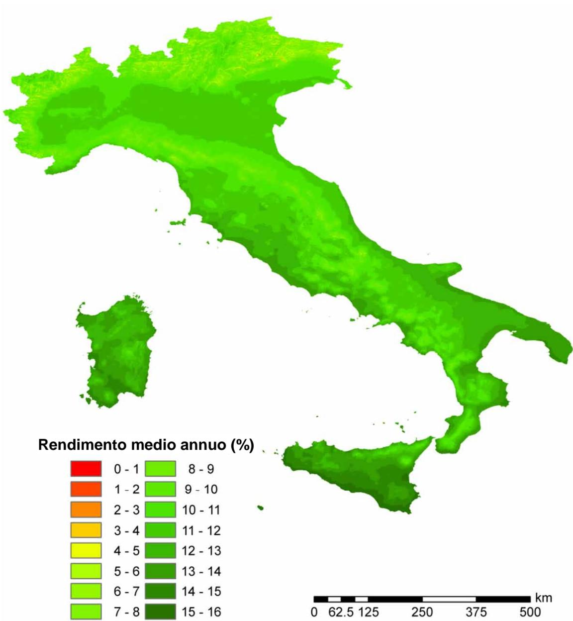
Figura 2.A2.32: Rendimento economico medio annuo di sistemi fotovoltaici da 10 kWh di potenza di picco su superficie inclinata di 32.5° verso sud: ipotesi di un completo utilizzo dell'energia elettrica prodotta
