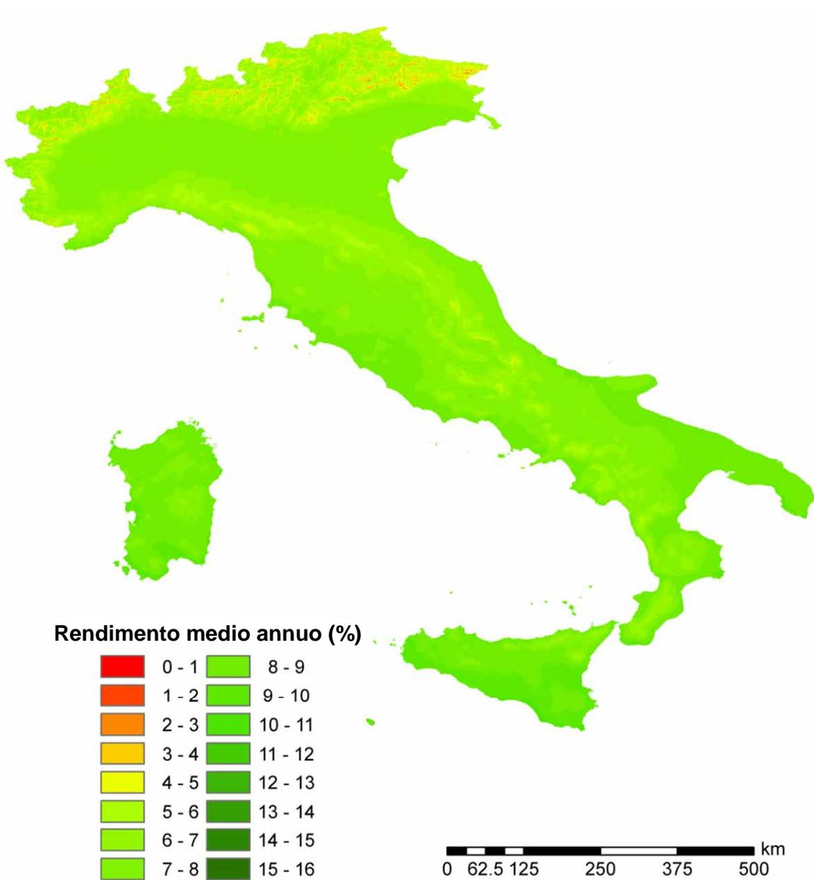
Figura 2.A2.28: Rendimento economico medio annuo di sistemi fotovoltaici da 10 kWh di potenza di picco su superficie inclinata di 45° verso sud: ipotesi di utilizzo dell'energia elettrica prodotta per 5000 kWh.
