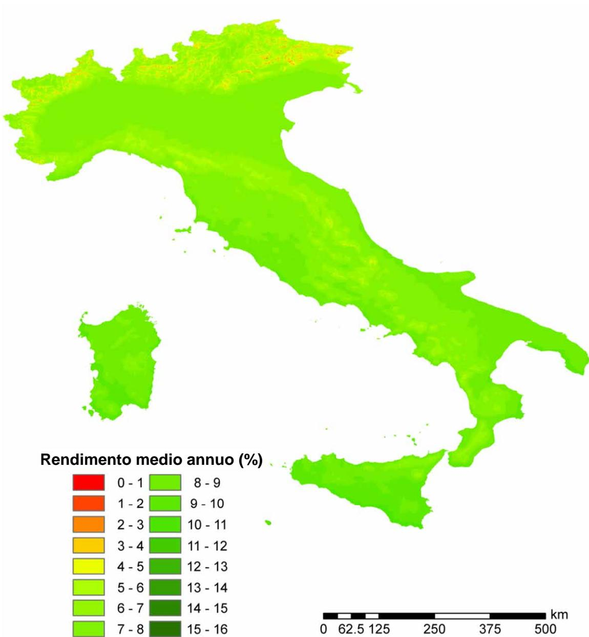
Figura 2.A2.27: Rendimento economico medio annuo di sistemi fotovoltaici da 10 kWh di potenza di picco su superficie inclinata di 40° verso sud: ipotesi di utilizzo dell'energia elettrica prodotta per 5000 kWh.
