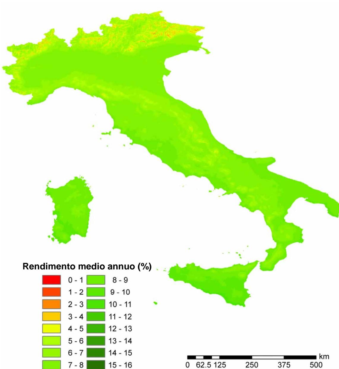
Figura 2.A2.3: Rendimento economico medio annuo di sistemi fotovoltaici da 5 kWh di potenza di picco su superficie inclinata di 30° verso sud: ipotesi di utilizzo dell'energia elettrica prodotta per 2300 kWh.
