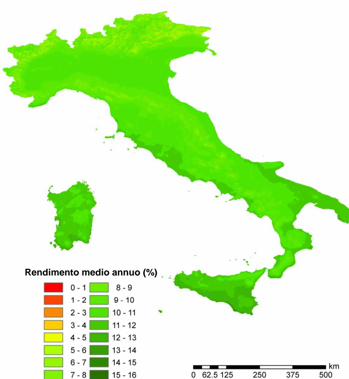
Figura 2.A2.13: Rendimento economico medio annuo di sistemi fotovoltaici da 5 kWh di potenza di picco su superficie inclinata di 40° verso sud: ipotesi di utilizzo dell'energia elettrica prodotta per 5000 kWh.
