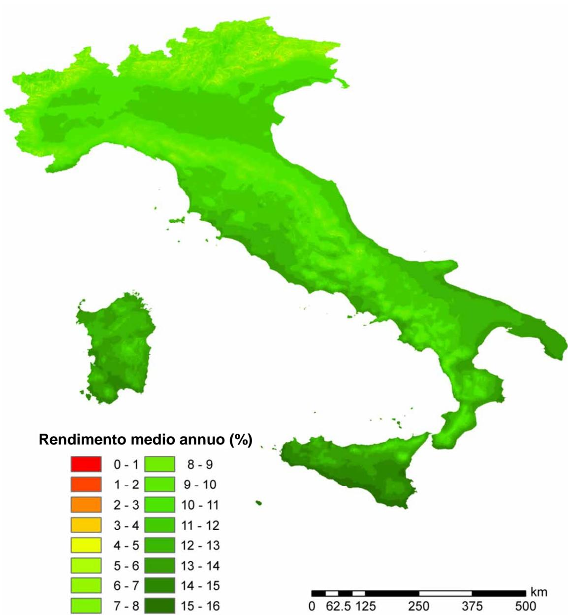
Figura 2.A2.30: Rendimento economico medio annuo di sistemi fotovoltaici da 10 kWh di potenza di picco su superficie inclinata di 25° verso sud: ipotesi di un completo utilizzo dell'energia elettrica prodotta
