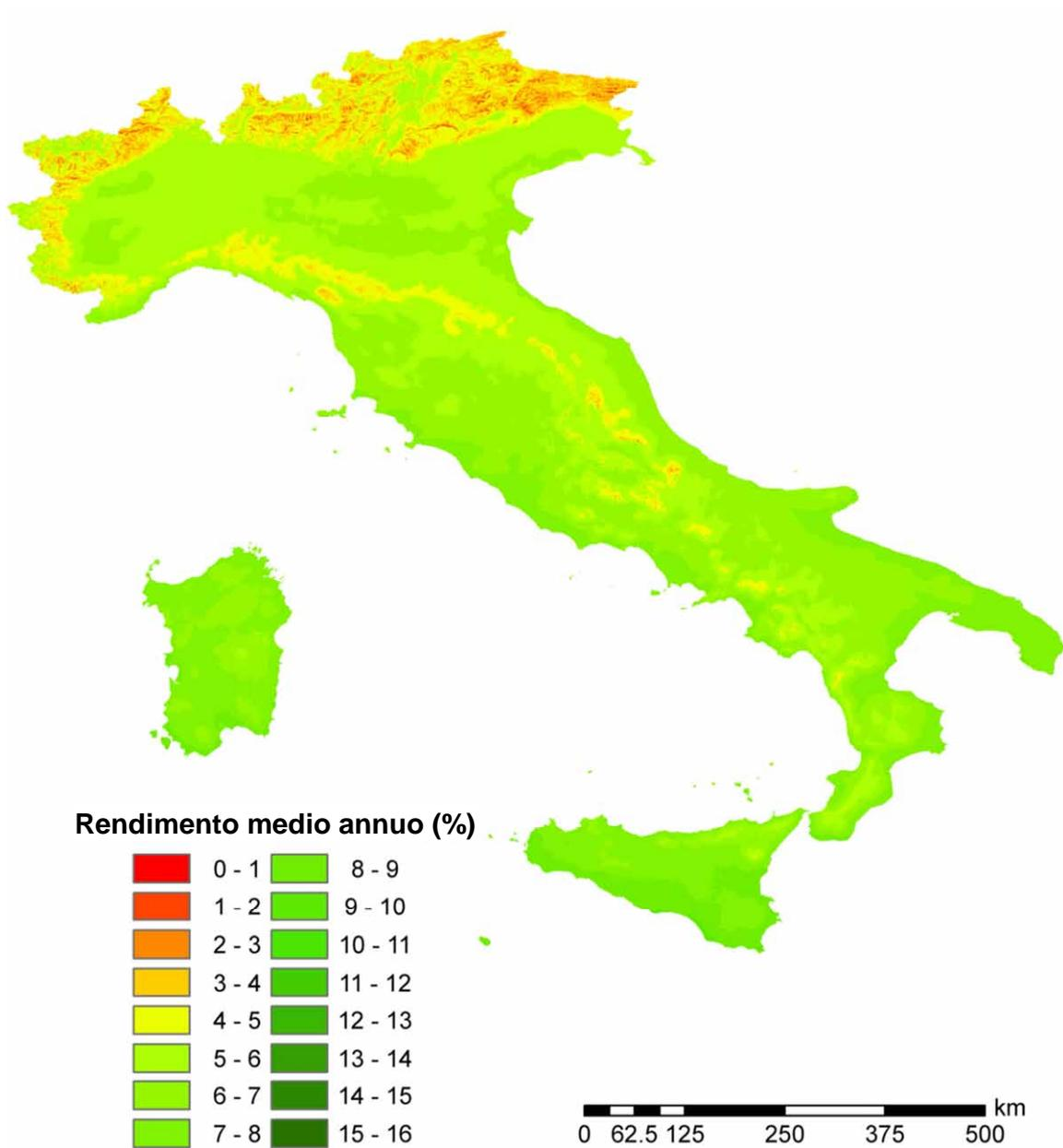
Figura 2.A2.16: Rendimento economico medio annuo di sistemi fotovoltaici da 10 kWh di potenza di picco su superficie inclinata di 25° verso sud: ipotesi di utilizzo dell'energia elettrica prodotta per 2300 kWh.
