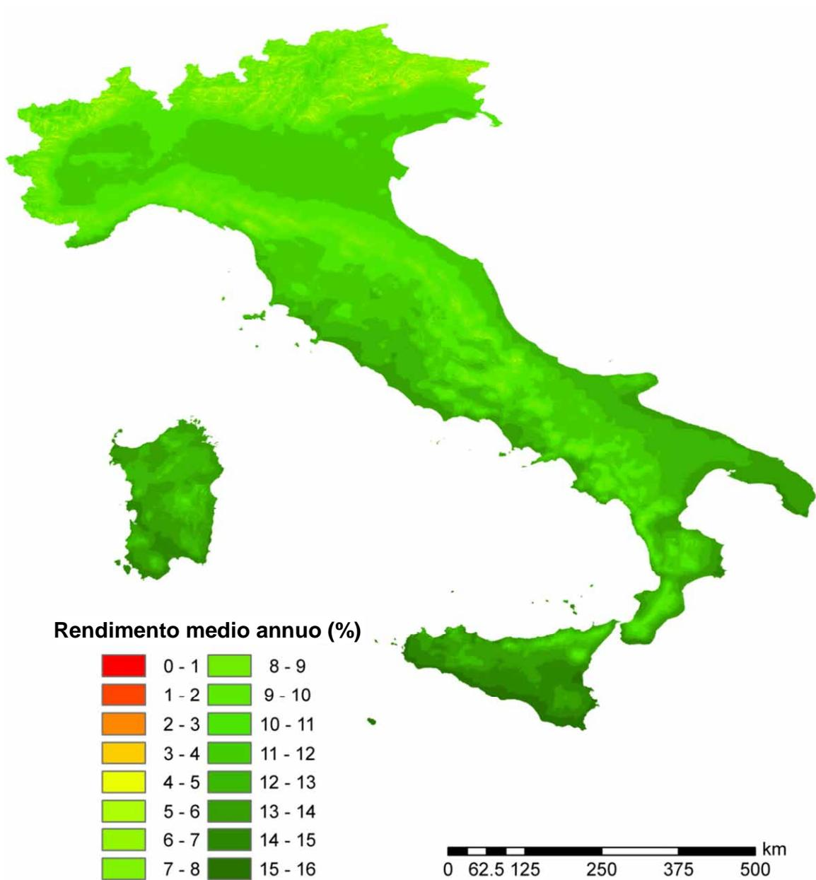
Figura 2.A2.31: Rendimento economico medio annuo di sistemi fotovoltaici da 10 kWh di potenza di picco su superficie inclinata di 30° verso sud: ipotesi di un completo utilizzo dell'energia elettrica prodotta
