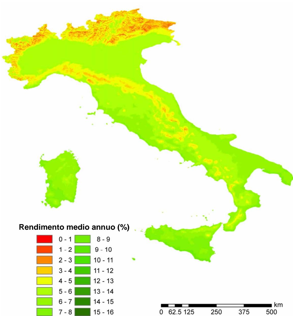
Figura 2.A2.41: Rendimento economico medio annuo di sistemi fotovoltaici da 15 kWh di potenza di picco su superficie inclinata di 40° verso sud: ipotesi di utilizzo dell'energia elettrica prodotta per 2300 kWh.
