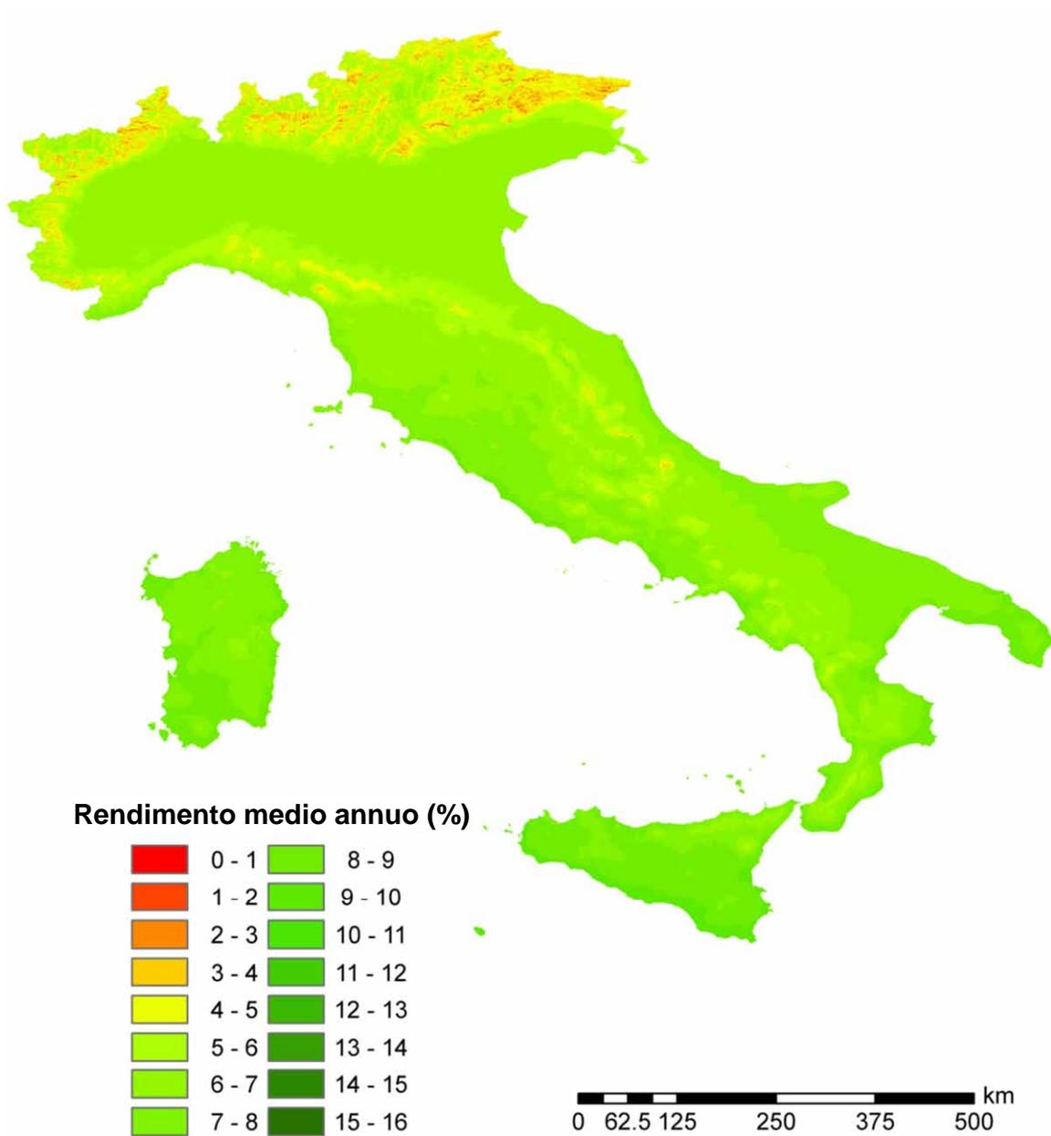
Figura 2.A2.44: Rendimento economico medio annuo di sistemi fotovoltaici da 15 kWh di potenza di picco su superficie inclinata di 25° verso sud: ipotesi di utilizzo dell'energia elettrica prodotta per 5000 kWh.
