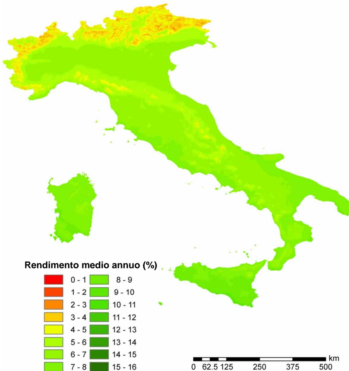
Figura 2.A2.1: Rendimento economico medio annuo di sistemi fotovoltaici da 5 kWh di potenza di picco su superficie orizzontale: ipotesi di utilizzo dell'energia elettrica prodotta per 2300 kWh.
