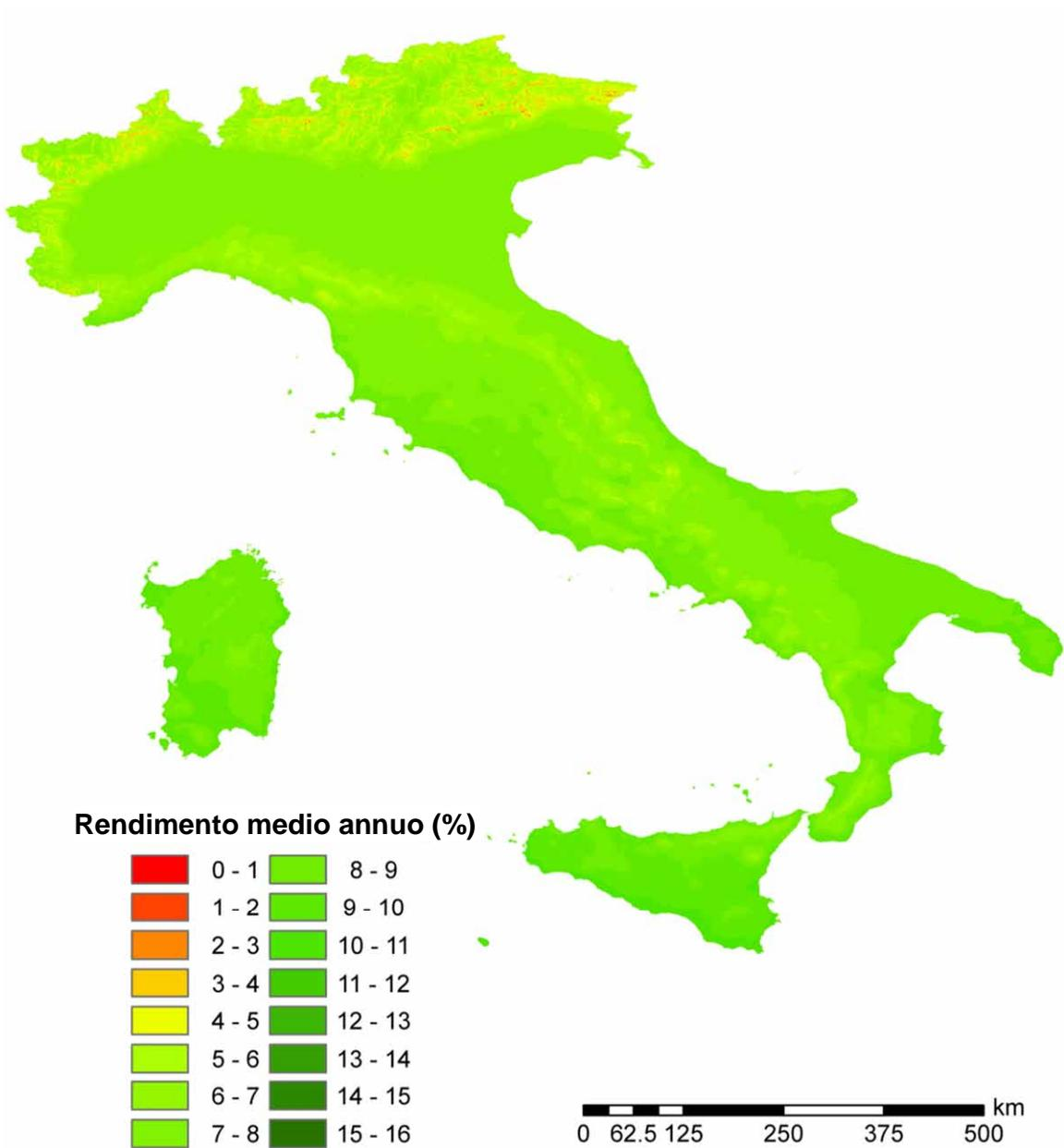
Figura 2.A2.24: Rendimento economico medio annuo di sistemi fotovoltaici da 10 kWh di potenza di picco su superficie inclinata di 30° verso sud: ipotesi di utilizzo dell'energia elettrica prodotta per 5000 kWh.
