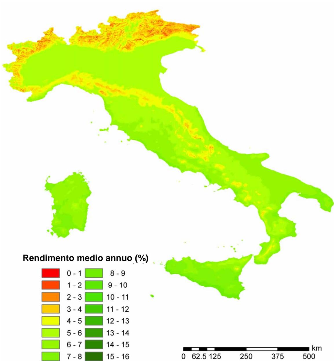
Figura 2.A2.39: Rendimento economico medio annuo di sistemi fotovoltaici da 15 kWh di potenza di picco su superficie inclinata di 32.5° verso sud: ipotesi di utilizzo dell'energia elettrica prodotta per 2300 kWh.
