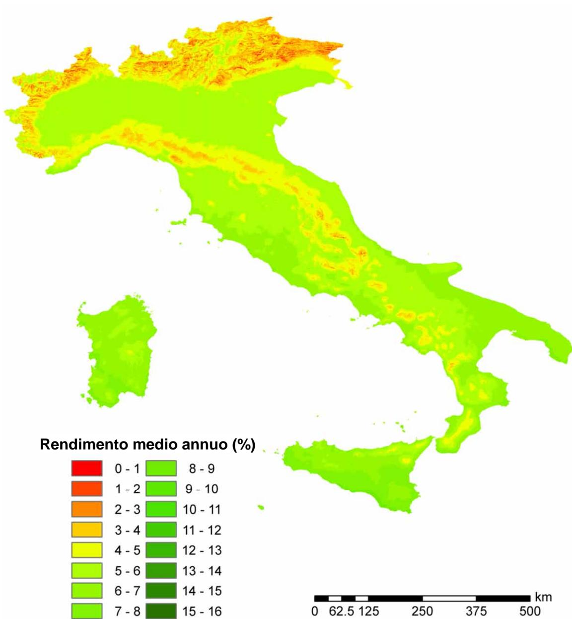
Figura 2.A2.42: Rendimento economico medio annuo di sistemi fotovoltaici da 15 kWh di potenza di picco su superficie inclinata di 45° verso sud: ipotesi di utilizzo dell'energia elettrica prodotta per 2300 kWh.
