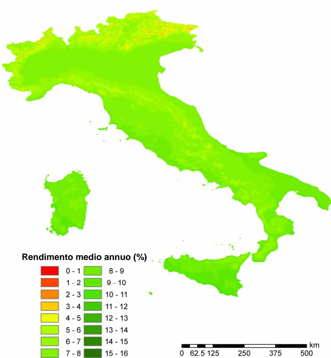
Figura 2.A2.5: Rendimento economico medio annuo di sistemi fotovoltaici da 5 kWh di potenza di picco su superficie inclinata di 35° verso sud: ipotesi di utilizzo dell'energia elettrica prodotta per 2300 kWh.
