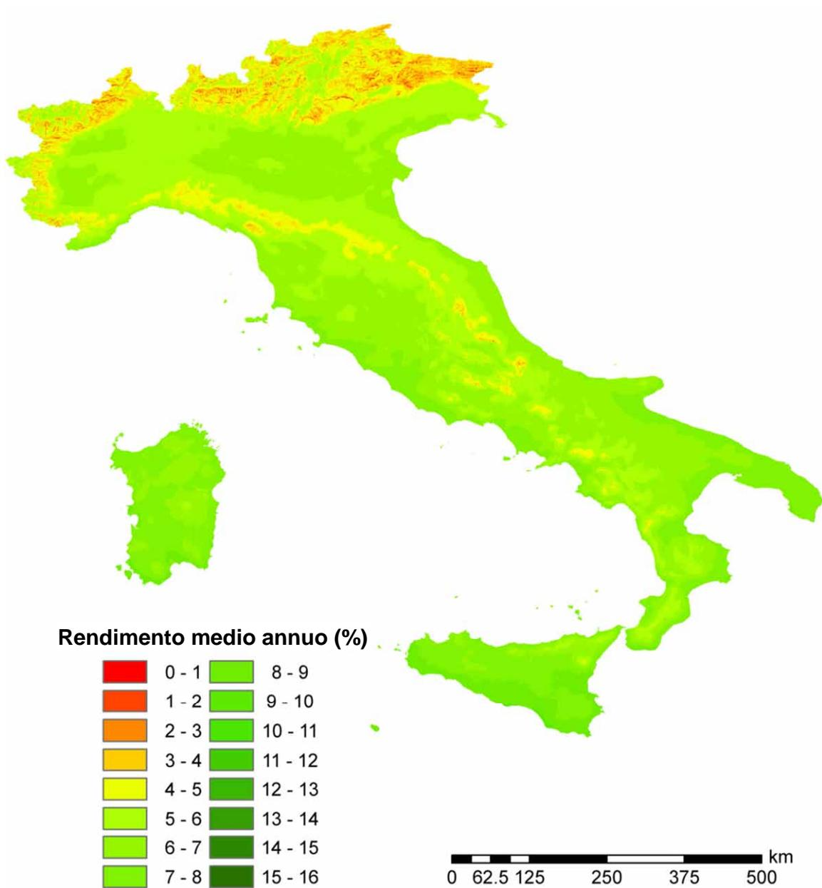
Figura 2.A2.18: Rendimento economico medio annuo di sistemi fotovoltaici da 10 kWh di potenza di picco su superficie inclinata di 32.5° verso sud: ipotesi di utilizzo dell'energia elettrica prodotta per 2300 kWh.
