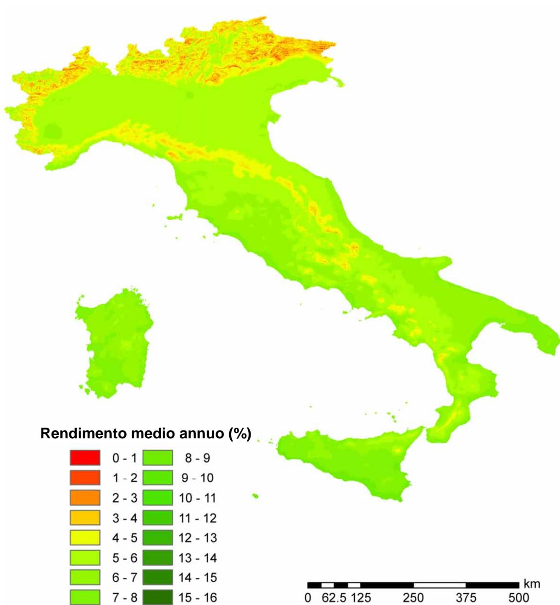
Figura 2.A2.21: Rendimento economico medio annuo di sistemi fotovoltaici da 10 kWh di potenza di picco su superficie inclinata di 45° verso sud: ipotesi di utilizzo dell'energia elettrica prodotta per 2300 kWh.
