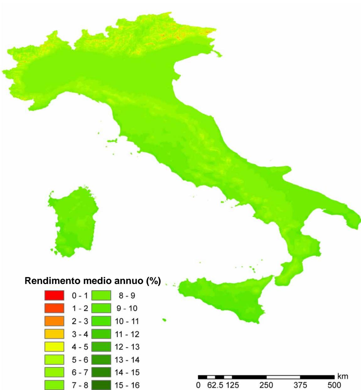
Figura 2.A2.26: Rendimento economico medio annuo di sistemi fotovoltaici da 10 kWh di potenza di picco su superficie inclinata di 35° verso sud: ipotesi di utilizzo dell'energia elettrica prodotta per 5000 kWh.
