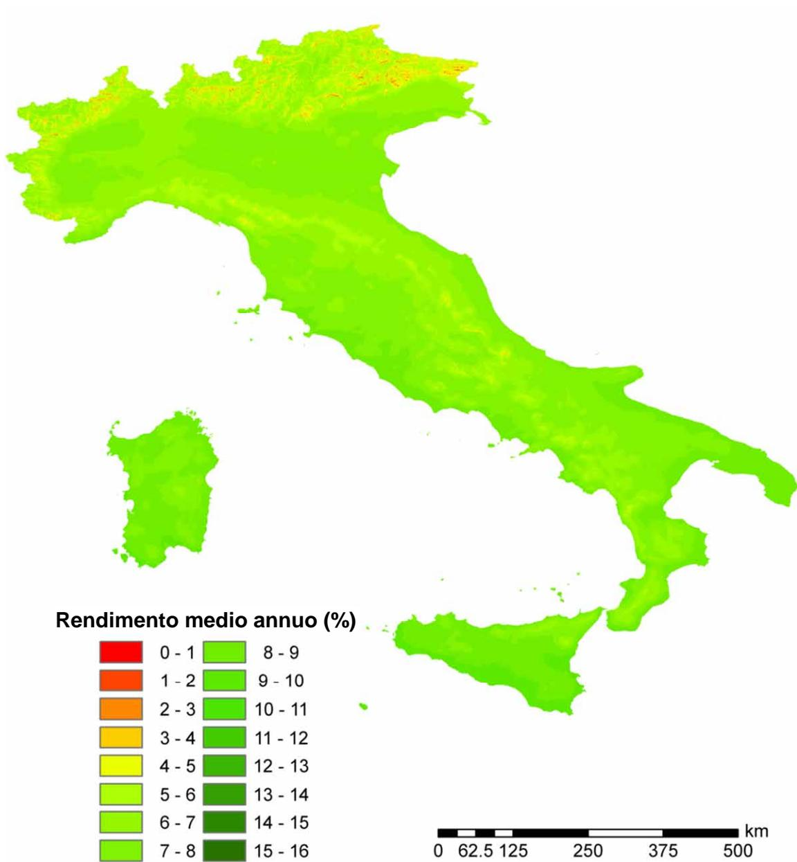
Figura 2.A2.7: Rendimento economico medio annuo di sistemi fotovoltaici da 5 kWh di potenza di picco su superficie inclinata di 45° verso sud: ipotesi di utilizzo dell'energia elettrica prodotta per 2300 kWh.
