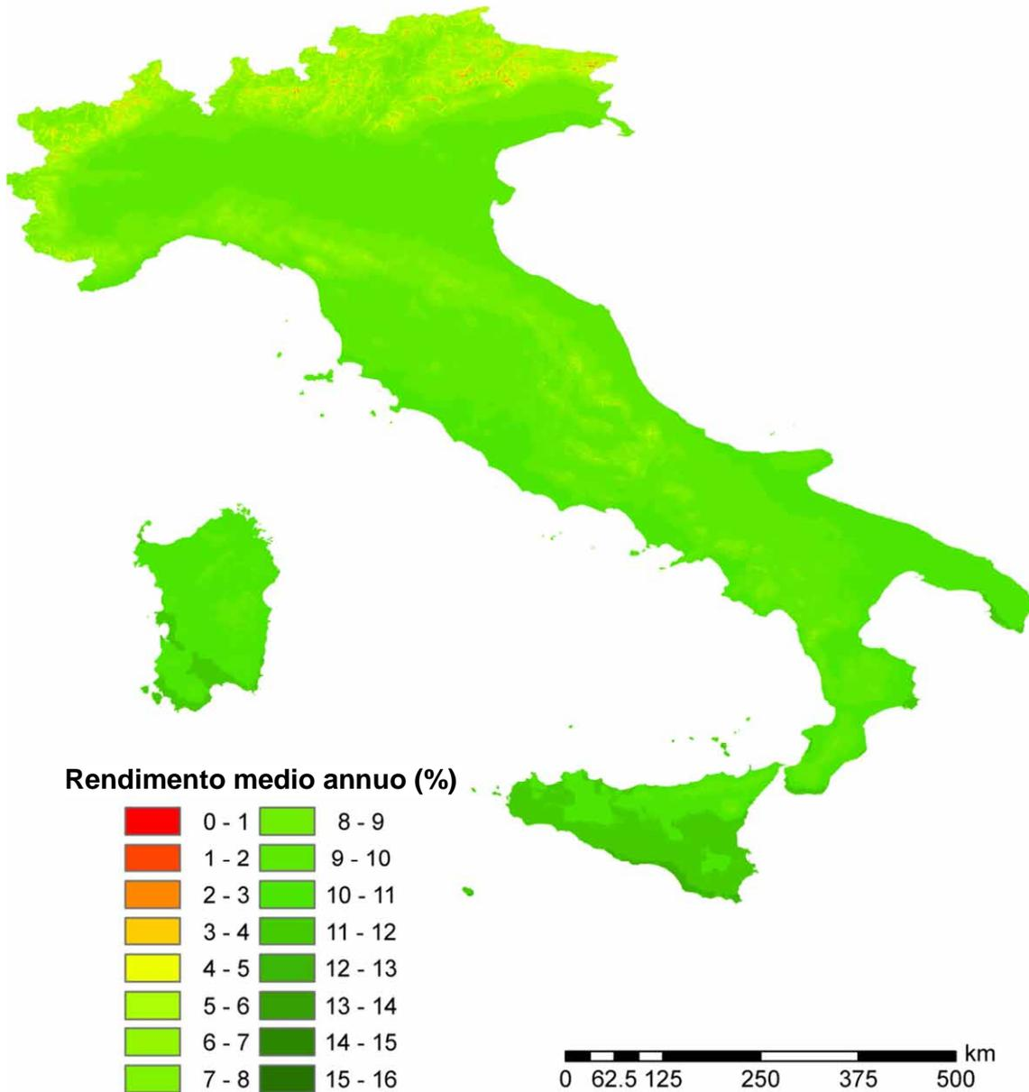
Figura 2.A2.8: Rendimento economico medio annuo di sistemi fotovoltaici da 5 kWh di potenza di picco su superficie orizzontale: ipotesi di utilizzo dell'energia elettrica prodotta per 5000 kWh.
