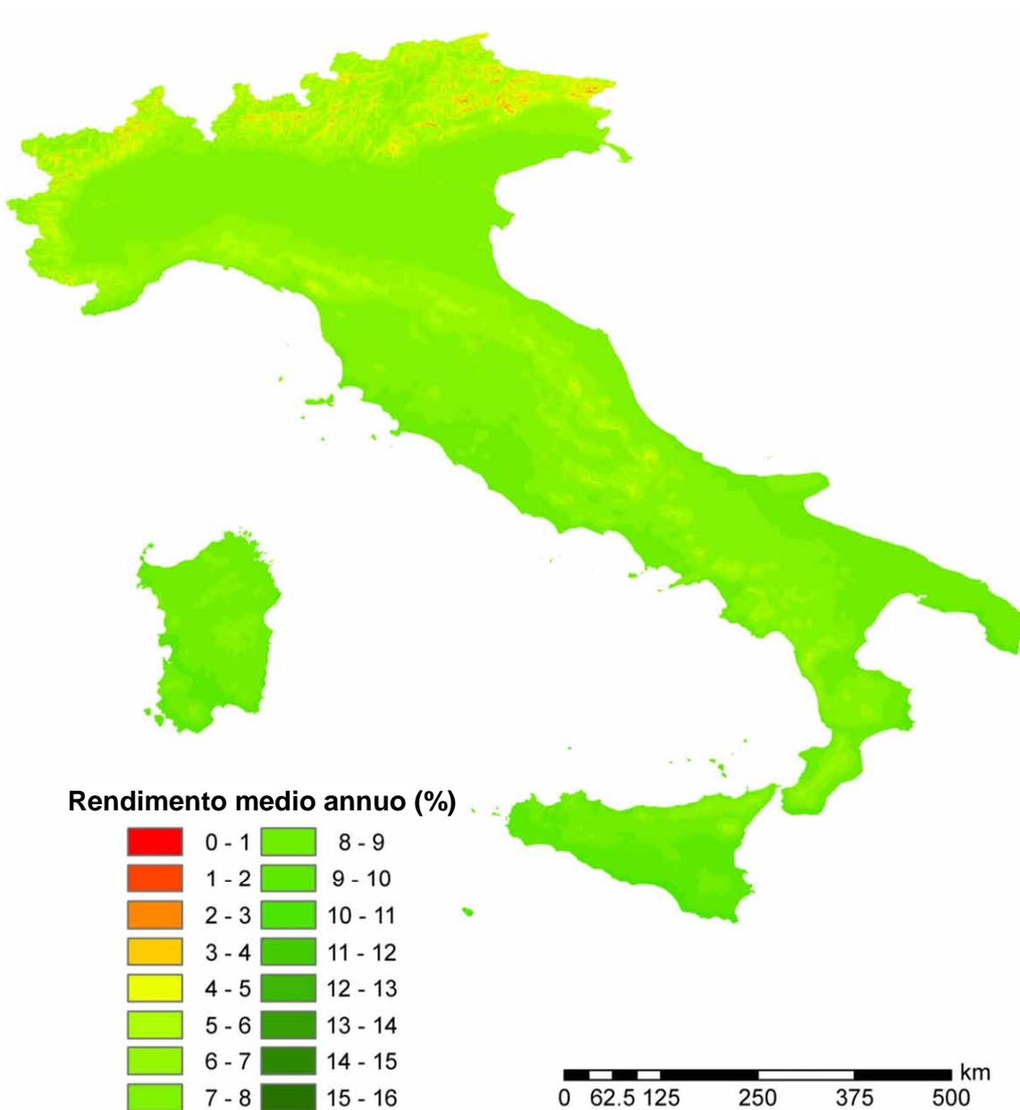
Figura 2.A2.4: Rendimento economico medio annuo di sistemi fotovoltaici da 5 kWh di potenza di picco su superficie inclinata di 32.5° verso sud: ipotesi di utilizzo dell'energia elettrica prodotta per 2300 kWh.
