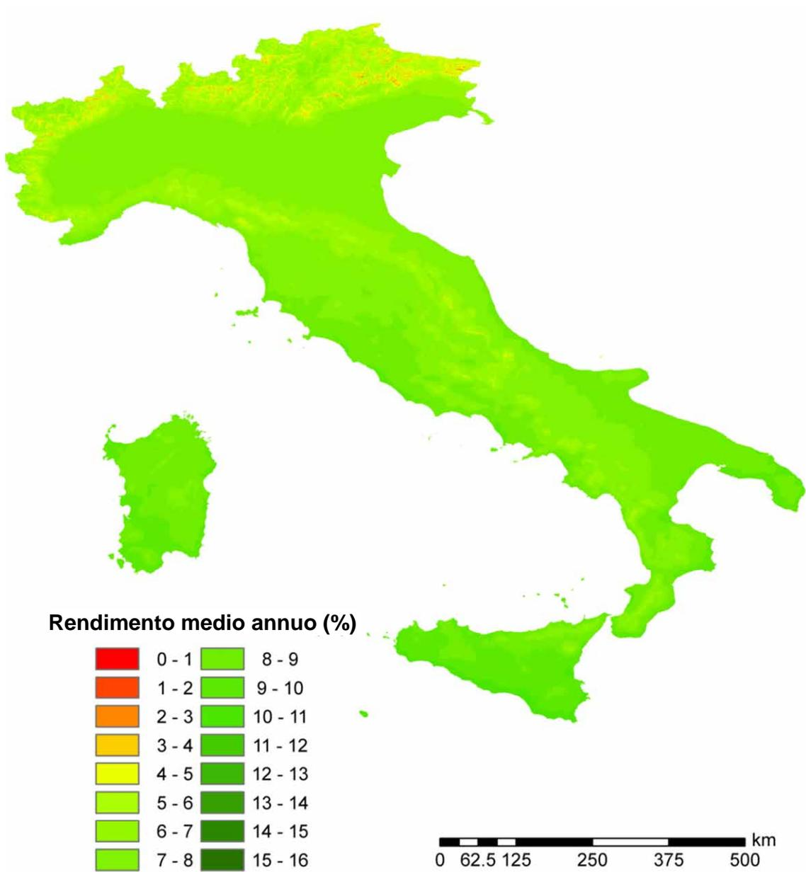
Figura 2.A2.23: Rendimento economico medio annuo di sistemi fotovoltaici da 10 kWh di potenza di picco su superficie inclinata di 25° verso sud: ipotesi di utilizzo dell'energia elettrica prodotta per 5000 kWh.
