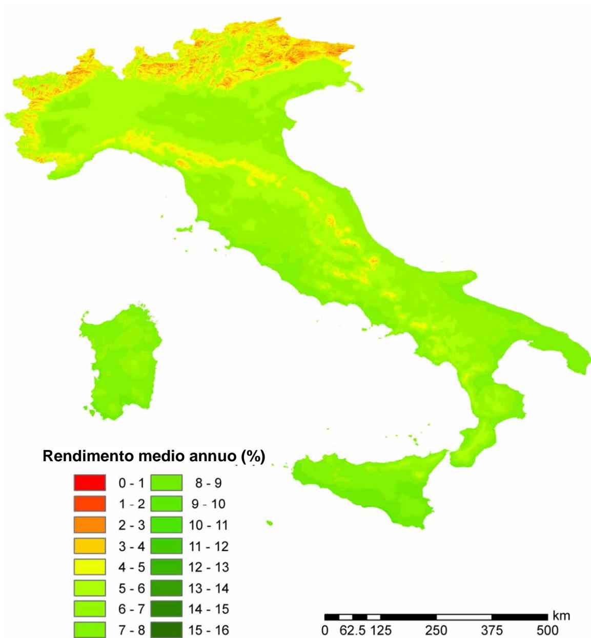
Figura 2.A2.17: Rendimento economico medio annuo di sistemi fotovoltaici da 10 kWh di potenza di picco su superficie inclinata di 30° verso sud: ipotesi di utilizzo dell'energia elettrica prodotta per 2300 kWh.
