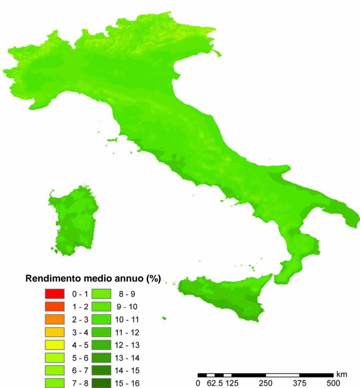
Figura 2.A2.14: Rendimento economico medio annuo di sistemi fotovoltaici da 5 kWh di potenza di picco su superficie inclinata di 45° verso sud: ipotesi di utilizzo dell'energia elettrica prodotta per 5000 kWh.
