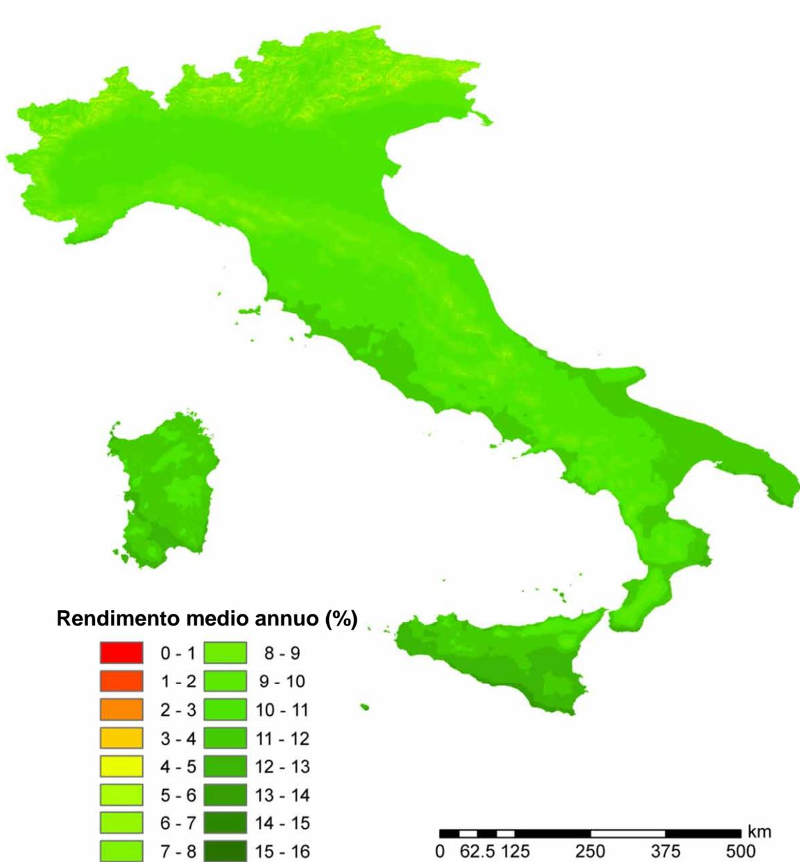
Figura 2.A2.12: Rendimento economico medio annuo di sistemi fotovoltaici da 5 kWh di potenza di picco su superficie inclinata di 35° verso sud: ipotesi di utilizzo dell'energia elettrica prodotta per 5000 kWh.
