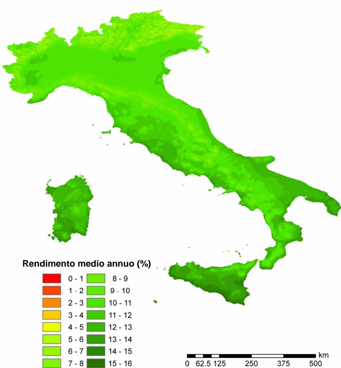
Figura 2.A2.35: Rendimento economico medio annuo di sistemi fotovoltaici da 10 kWh di potenza di picco su superficie inclinata di 45° verso sud: ipotesi di un completo utilizzo dell'energia elettrica prodotta
