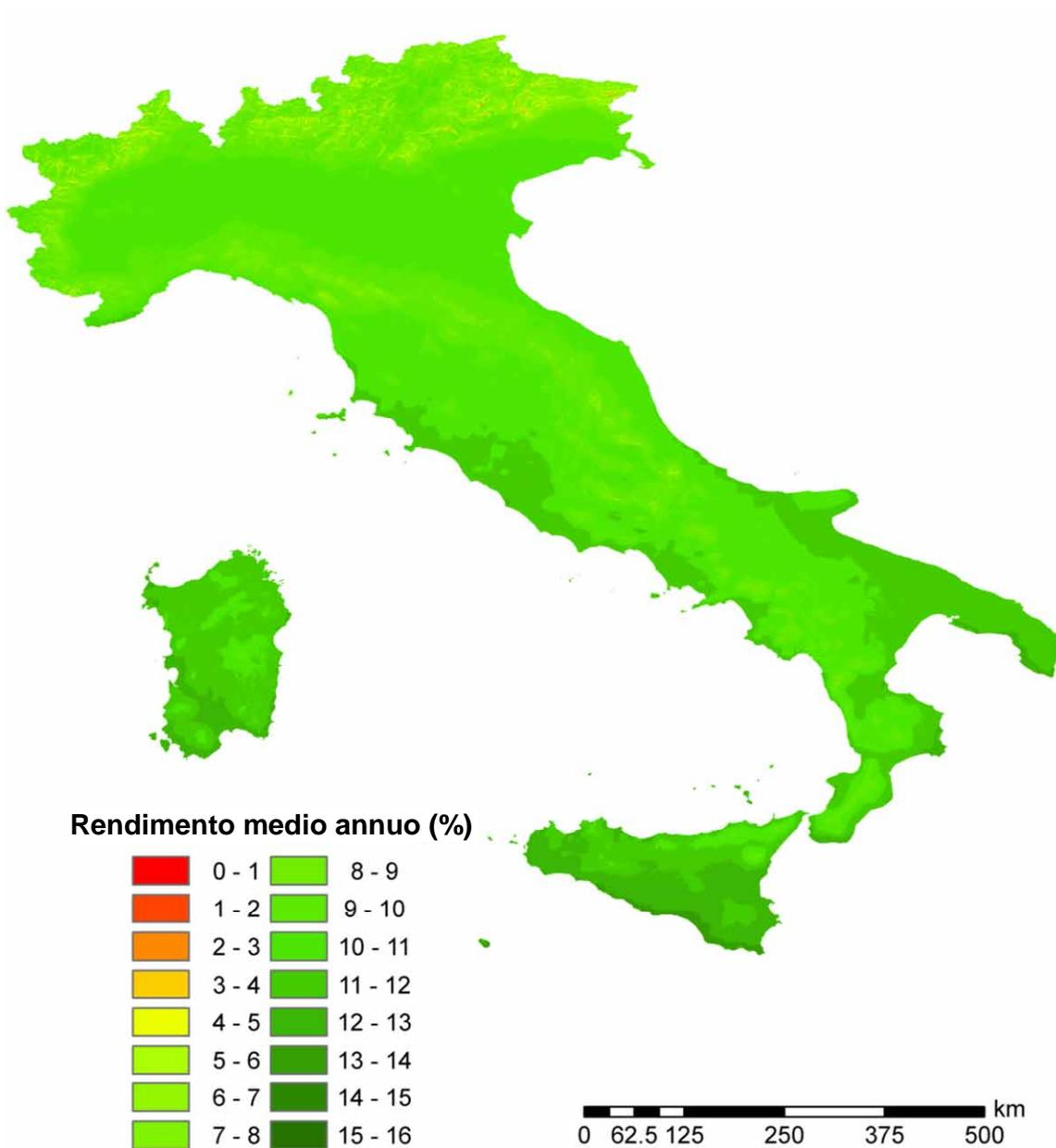
Figura 2.A2.10: Rendimento economico medio annuo di sistemi fotovoltaici da 5 kWh di potenza di picco su superficie inclinata di 30° verso sud: ipotesi di utilizzo dell'energia elettrica prodotta per 5000 kWh.
