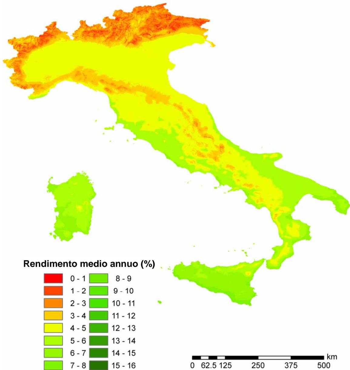
Figura 2.A2.36: Rendimento economico medio annuo di sistemi fotovoltaici da 15 kWh di potenza di picco su superficie orizzontale: ipotesi di utilizzo dell'energia elettrica prodotta per 2300 kWh.
