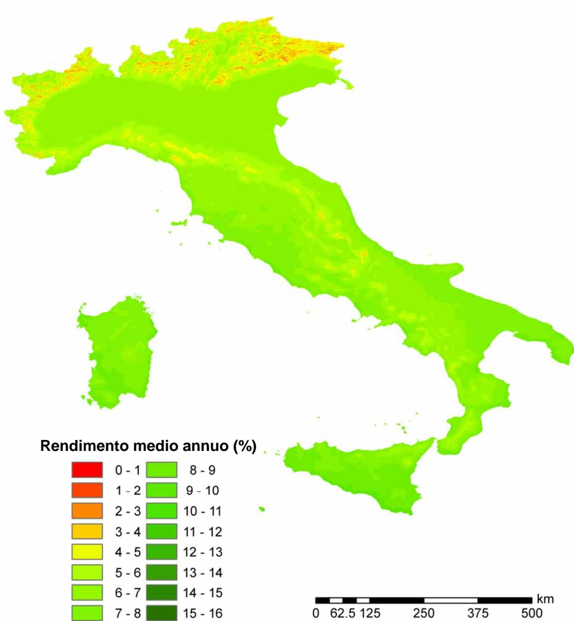
Figura 2.A2.48: Rendimento economico medio annuo di sistemi fotovoltaici da 15 kWh di potenza di picco su superficie inclinata di 40° verso sud: ipotesi di utilizzo dell'energia elettrica prodotta per 5000 kWh.
