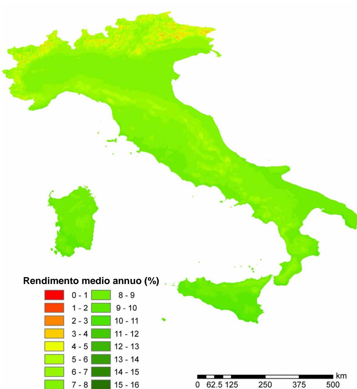
Figura 2.A2.2: Rendimento economico medio annuo di sistemi fotovoltaici da 5 kWh di potenza di picco su superficie inclinata di 25° verso sud: ipotesi di utilizzo dell'energia elettrica prodotta per 2300 kWh.
