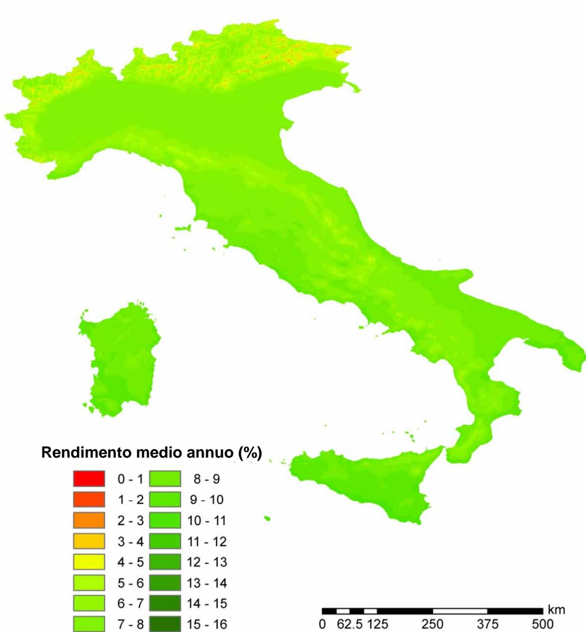
Figura 2.A2.25: Rendimento economico medio annuo di sistemi fotovoltaici da 10 kWh di potenza di picco su superficie inclinata di 32.5° verso sud: ipotesi di utilizzo dell'energia elettrica prodotta per 5000 kWh.
