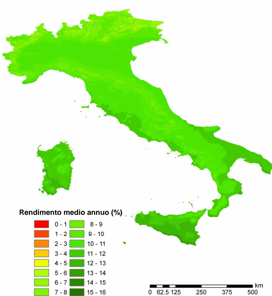
Figura 2.A2.9: Rendimento economico medio annuo di sistemi fotovoltaici da 5 kWh di potenza di picco su superficie inclinata di 25° verso sud: ipotesi di utilizzo dell'energia elettrica prodotta per 5000 kWh.
