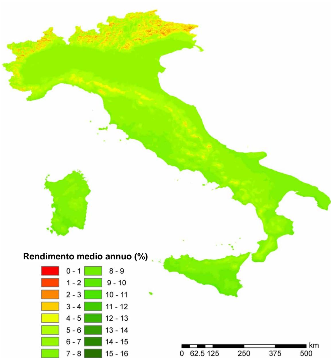
Figura 2.A2.49: Rendimento economico medio annuo di sistemi fotovoltaici da 15 kWh di potenza di picco su superficie inclinata di 45° verso sud: ipotesi di utilizzo dell'energia elettrica prodotta per 5000 kWh.
