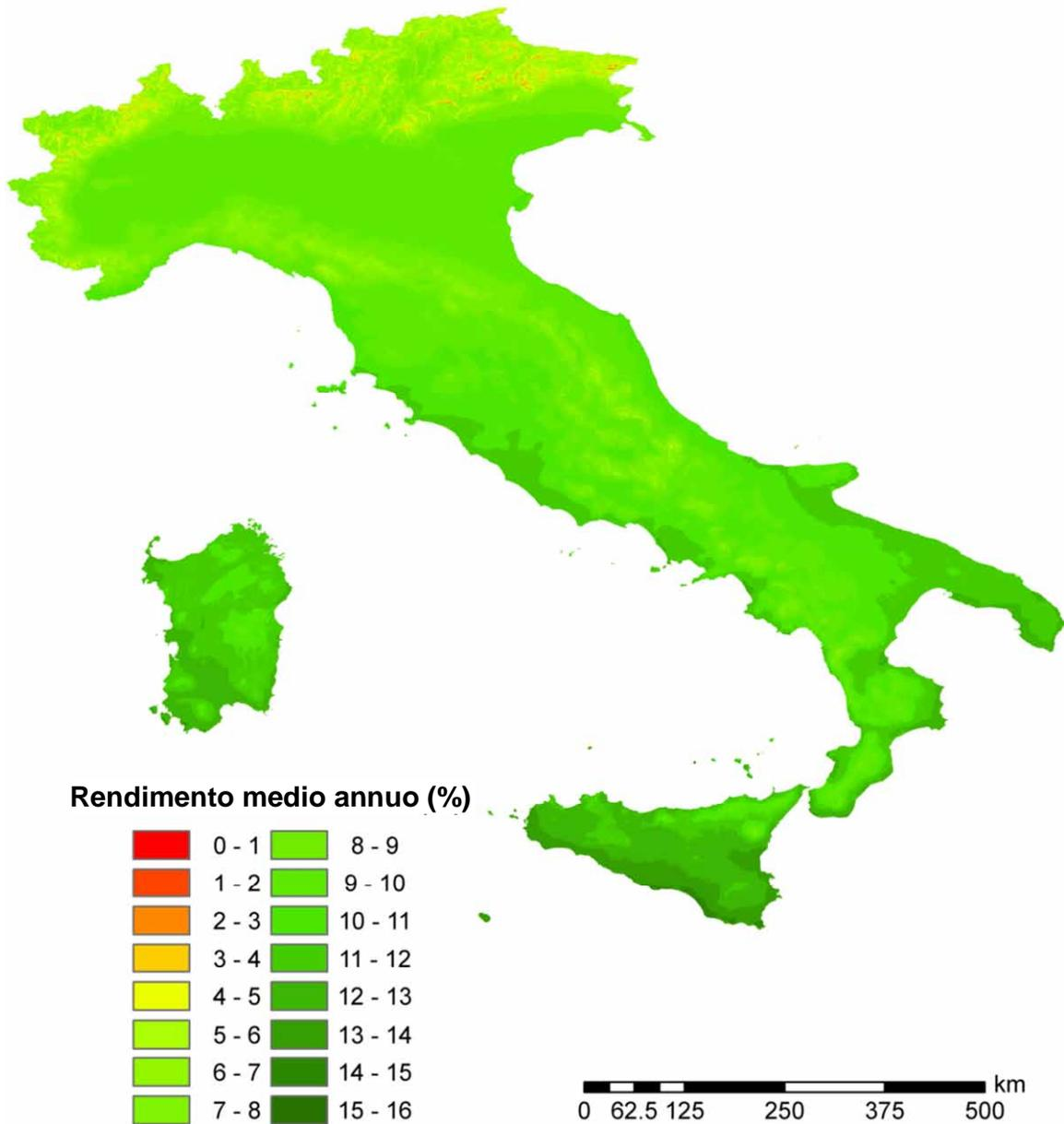
Figura 2.A2.29: Rendimento economico medio annuo di sistemi fotovoltaici da 10 kWh di potenza di picco su superficie orizzontale: ipotesi di un completo utilizzo dell'energia elettrica prodotta.
