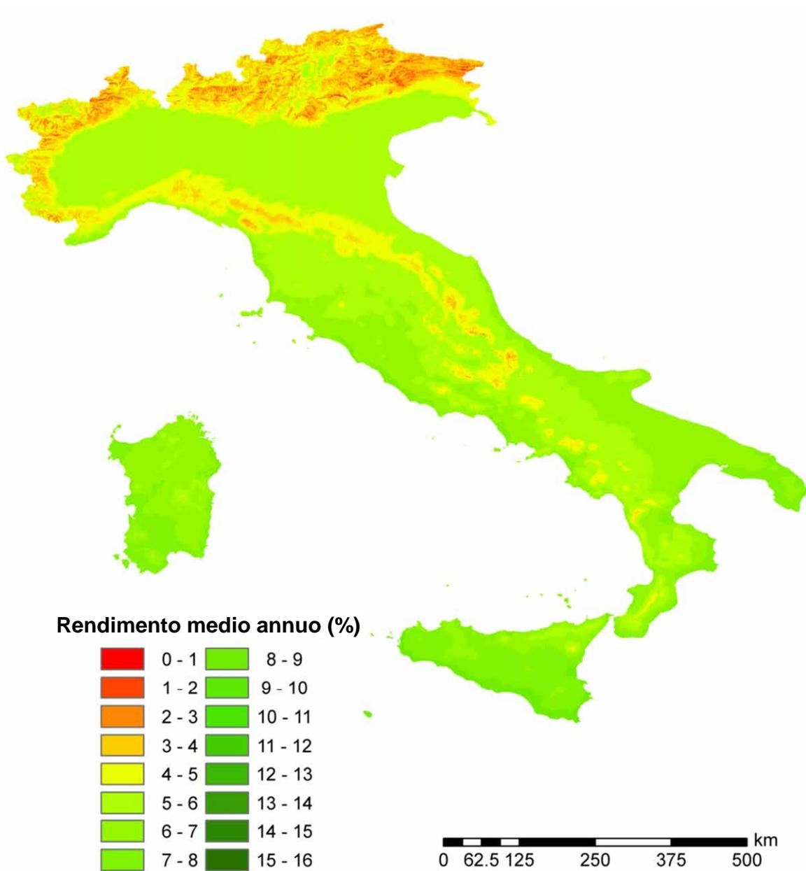
Figura 2.A2.37: Rendimento economico medio annuo di sistemi fotovoltaici da 15 kWh di potenza di picco su superficie inclinata di 25° verso sud: ipotesi di utilizzo dell'energia elettrica prodotta per 2300 kWh.
