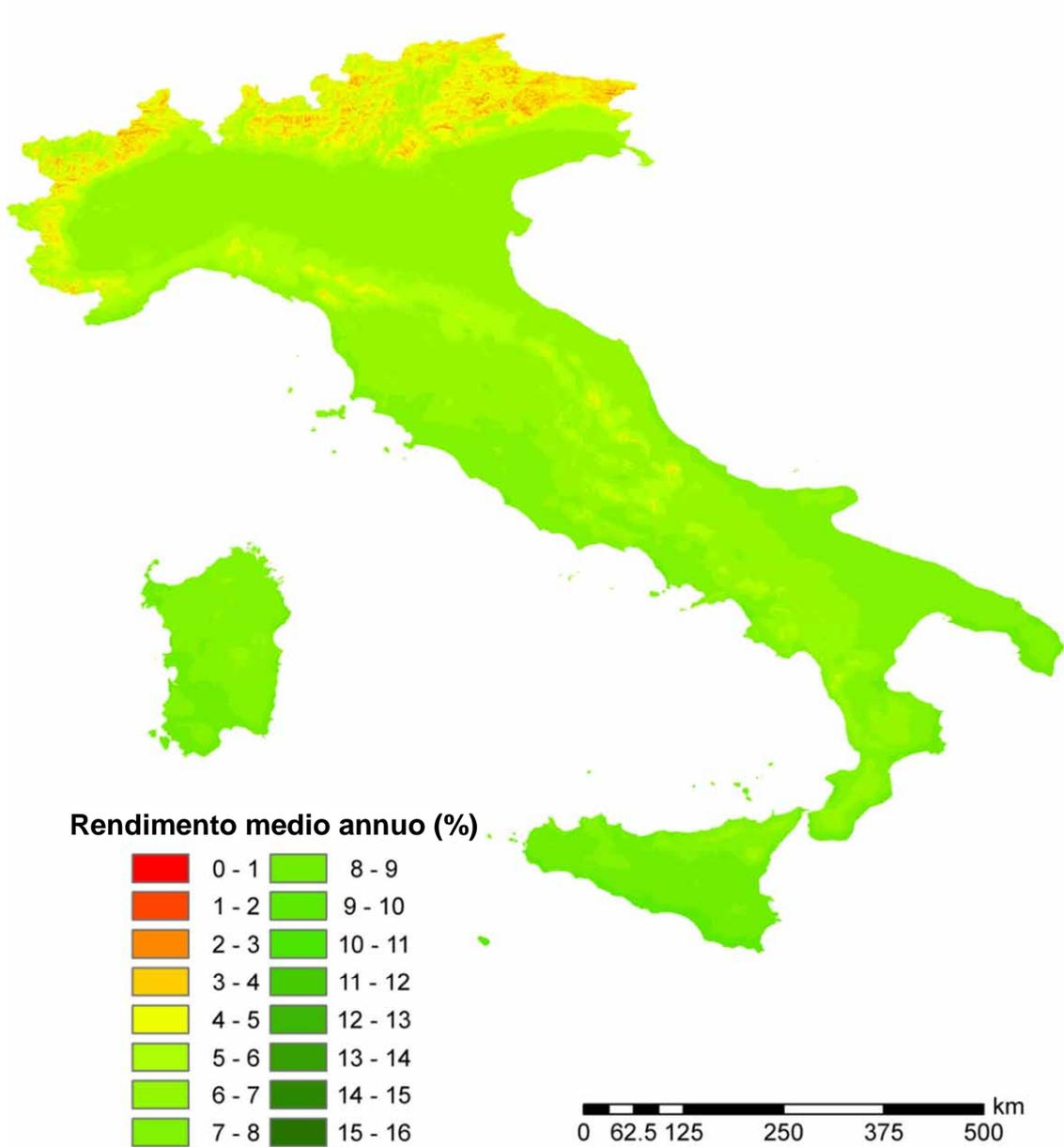
Figura 2.A2.22: Rendimento economico medio annuo di sistemi fotovoltaici da 10 kWh di potenza di picco su superficie orizzontale: ipotesi di utilizzo dell'energia elettrica prodotta per 5000 kWh.
