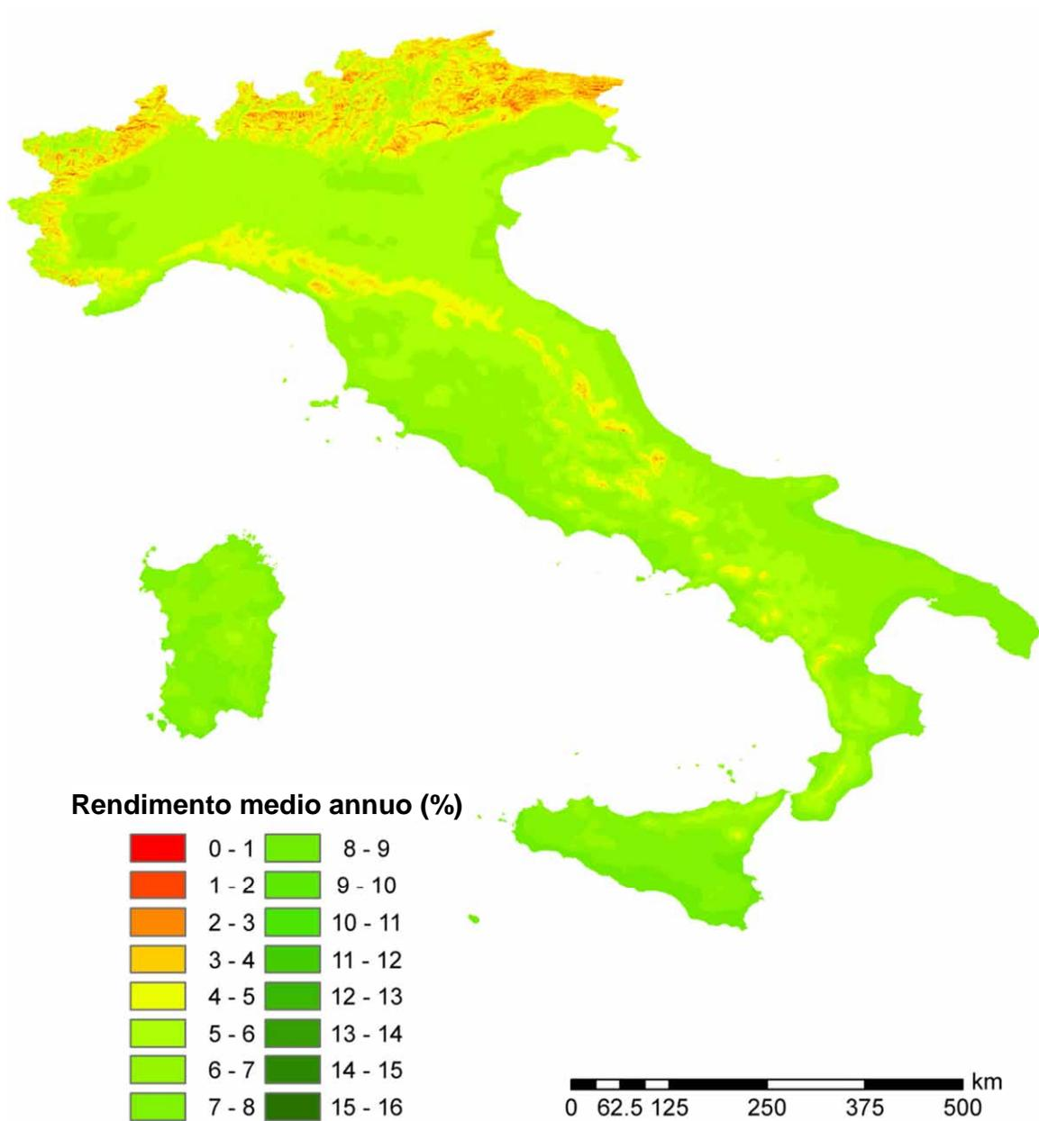
Figura 2.A2.20: Rendimento economico medio annuo di sistemi fotovoltaici da 10 kWh di potenza di picco su superficie inclinata di 40° verso sud: ipotesi di utilizzo dell'energia elettrica prodotta per 2300 kWh.
