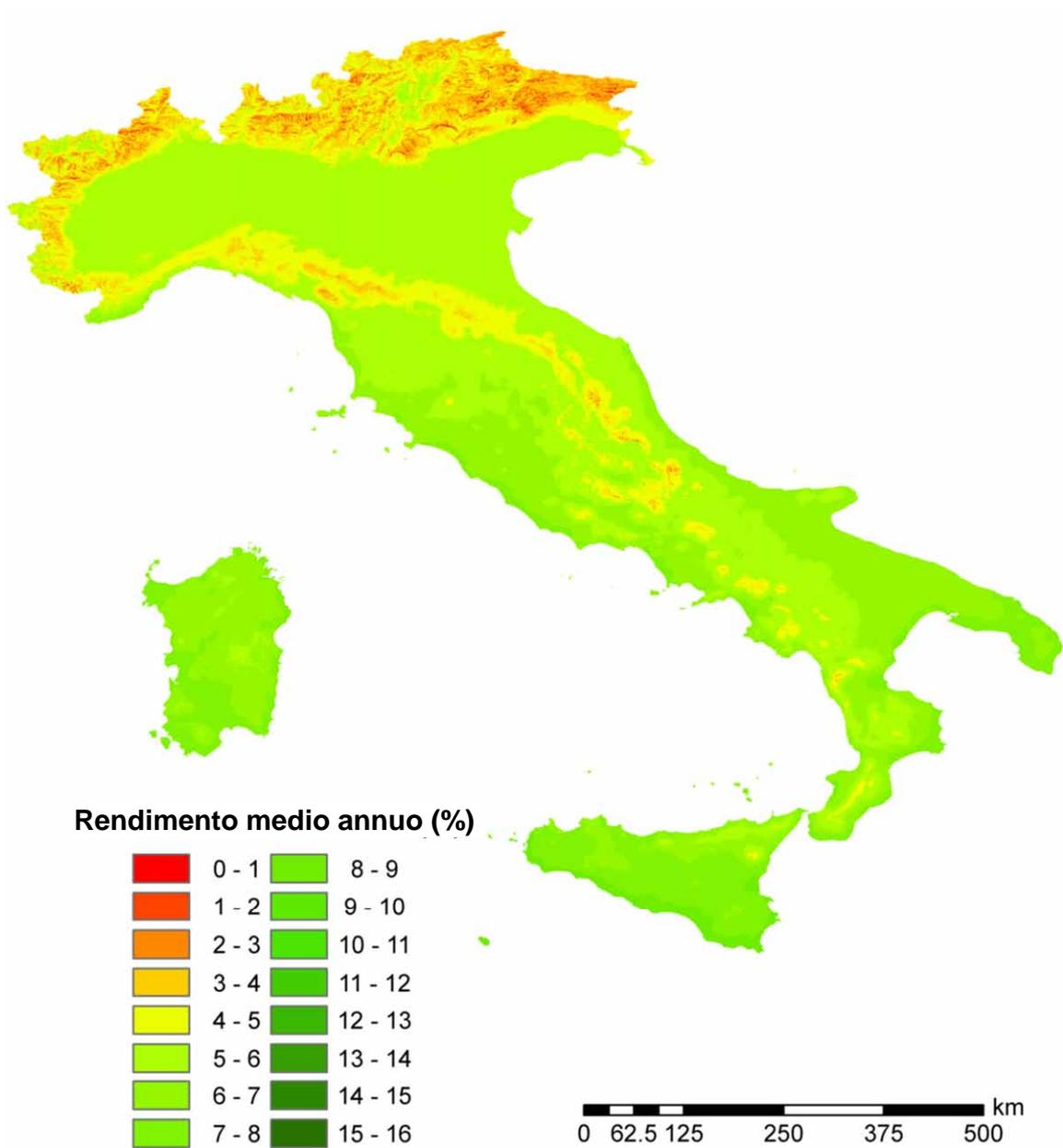
Figura 2.A2.38: Rendimento economico medio annuo di sistemi fotovoltaici da 15 kWh di potenza di picco su superficie inclinata di 30° verso sud: ipotesi di utilizzo dell'energia elettrica prodotta per 2300 kWh.
