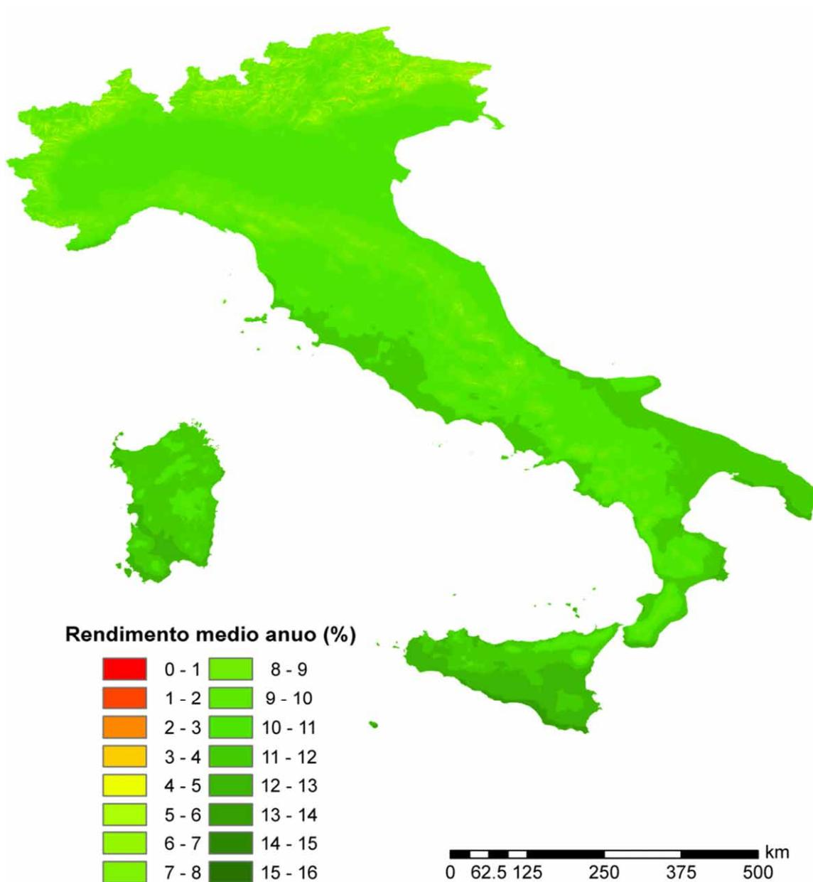
Figura 2.A2.11: Rendimento economico medio annuo di sistemi fotovoltaici da 5 kWh di potenza di picco su superficie inclinata di 32.5° verso sud: ipotesi di utilizzo dell'energia elettrica prodotta per 5000 kWh.
