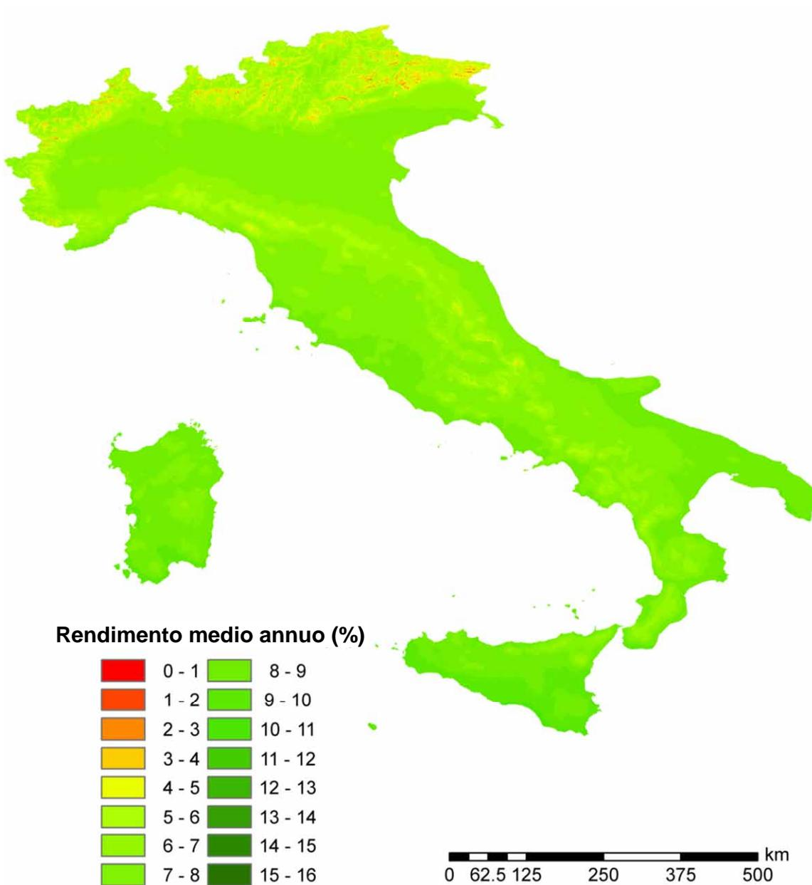
Figura 2.A2.6: Rendimento economico medio annuo di sistemi fotovoltaici da 5 kWh di potenza di picco su superficie inclinata di 40° verso sud: ipotesi di utilizzo dell'energia elettrica prodotta per 2300 kWh.
