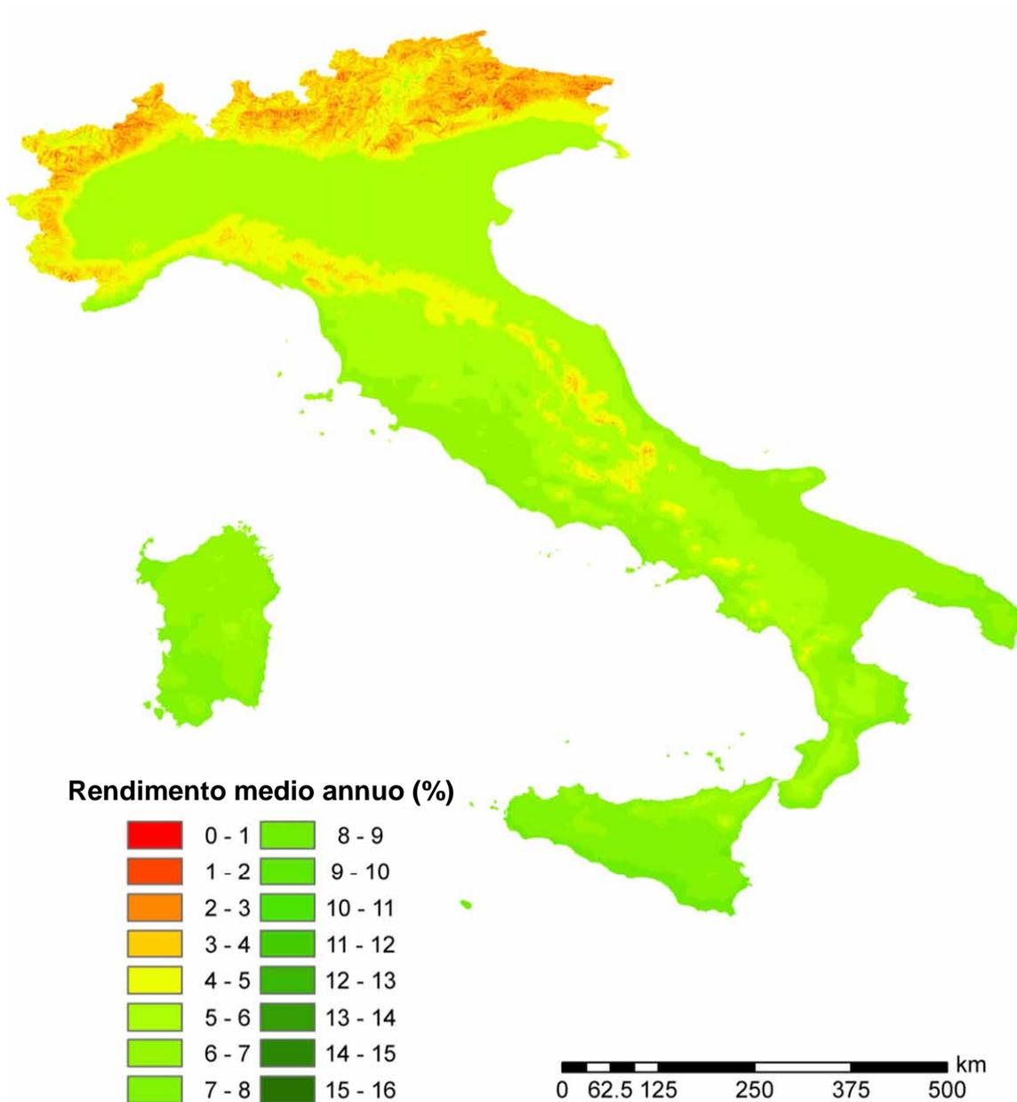
Figura 2.A2.43: Rendimento economico medio annuo di sistemi fotovoltaici da 15 kWh di potenza di picco su superficie orizzontale: ipotesi di utilizzo dell'energia elettrica prodotta per 5000 kWh.
