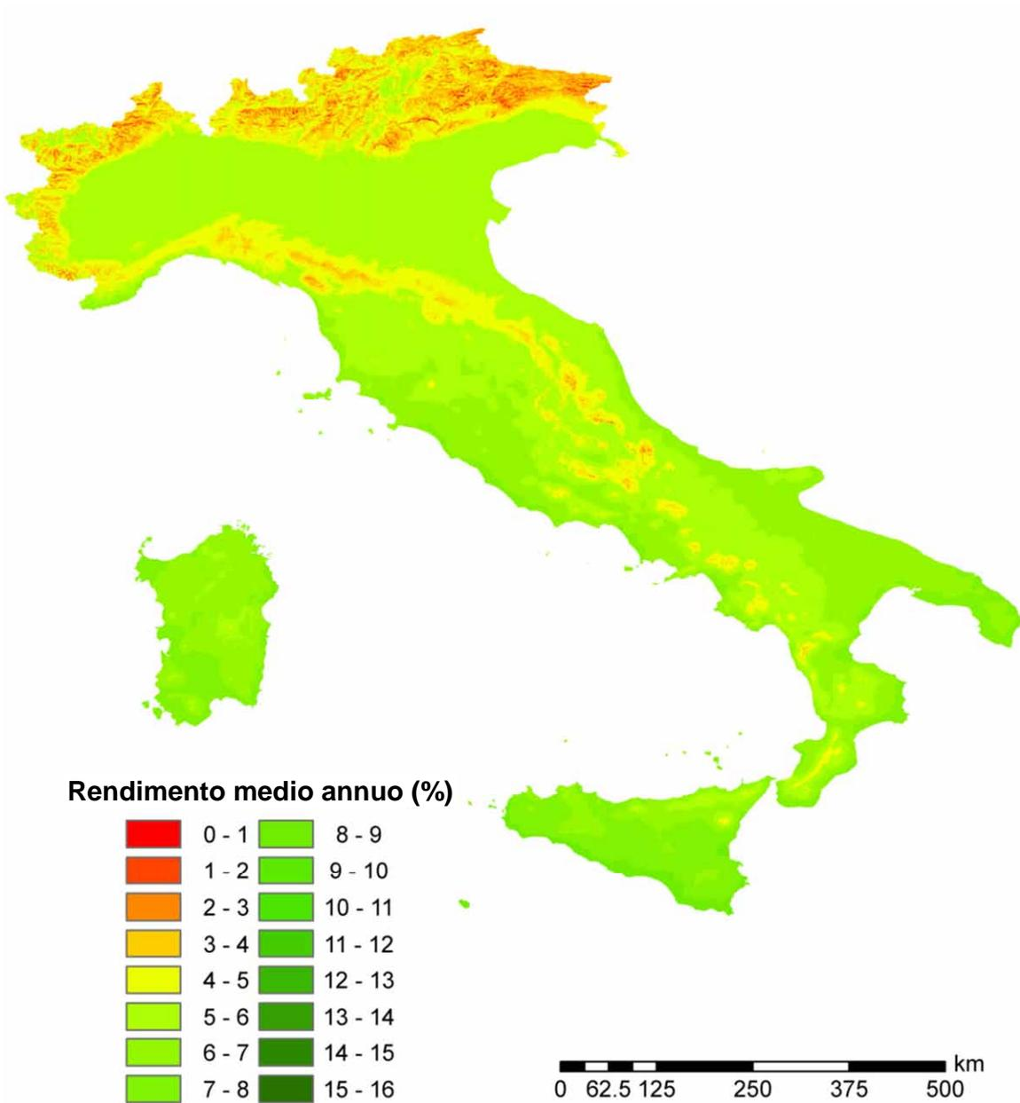
Figura 2.A2.40: Rendimento economico medio annuo di sistemi fotovoltaici da 15 kWh di potenza di picco su superficie inclinata di 35° verso sud: ipotesi di utilizzo dell'energia elettrica prodotta per 2300 kWh.
