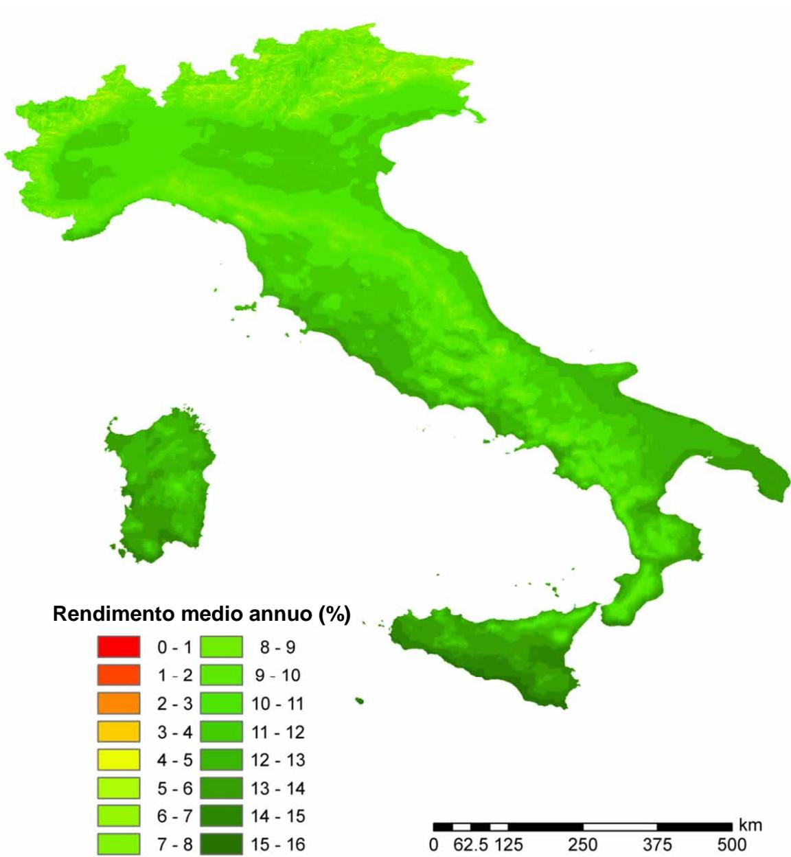
Figura 2.A2.34: Rendimento economico medio annuo di sistemi fotovoltaici da 10 kWh di potenza di picco su superficie inclinata di 40° verso sud: ipotesi di un completo utilizzo dell'energia elettrica prodotta
