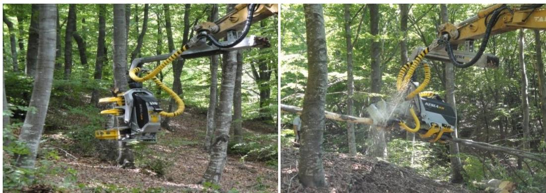
**Fig. 13** Processore Kesla montato su escavatore, in fase di abbattimento
