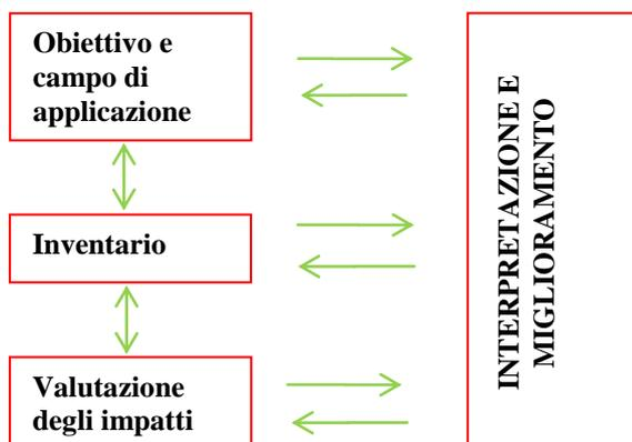
**Fig.7** Struttura della LCA proposta dalla norma ISO14040
