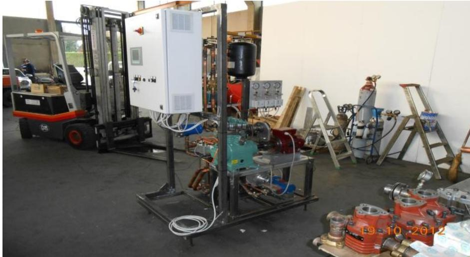
**Fig 16** Sistema ORC per microgenerazione termo elettrica
