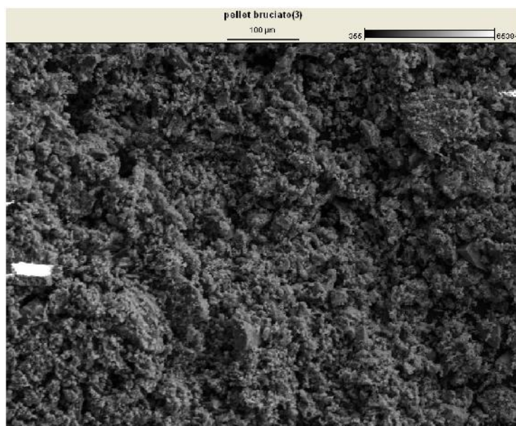
Figura 18: Ceneri del campione “Pellets di vite”, visione a 200 ingrandimenti.
