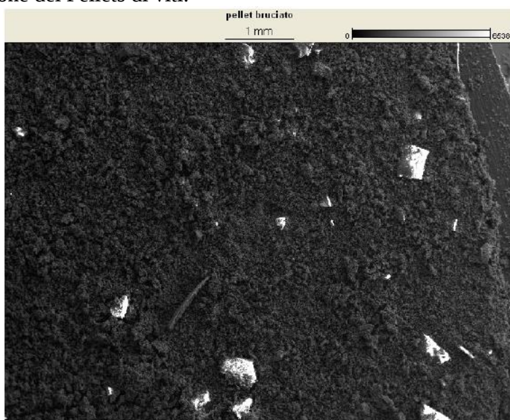
Figura 17: Ceneri del campione “Pellets di vite”, visione a 20 ingrandimenti.
