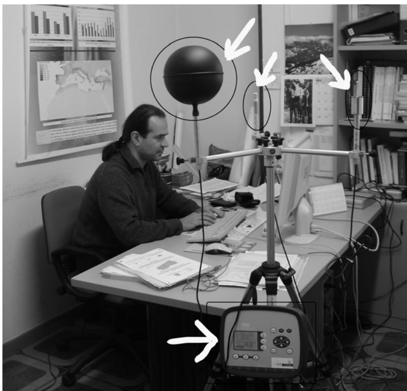
Figura 15: Stazione biometeorologica per il monitoraggio del microclima in ambiente indoor.
