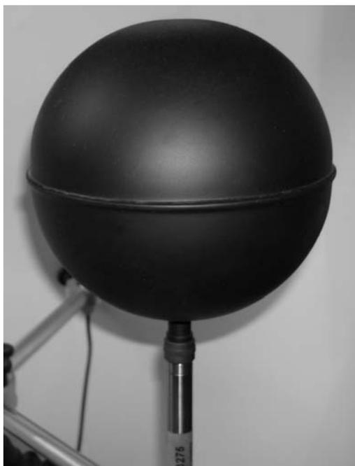
Figura 11: Globotermometro di Vernon utilizzato per il calcolo della Temperatura media radiante.
