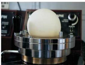
Foto di una bolla di pasta durante la misurazione dei parametri mediante l'alveografo di Chopin
