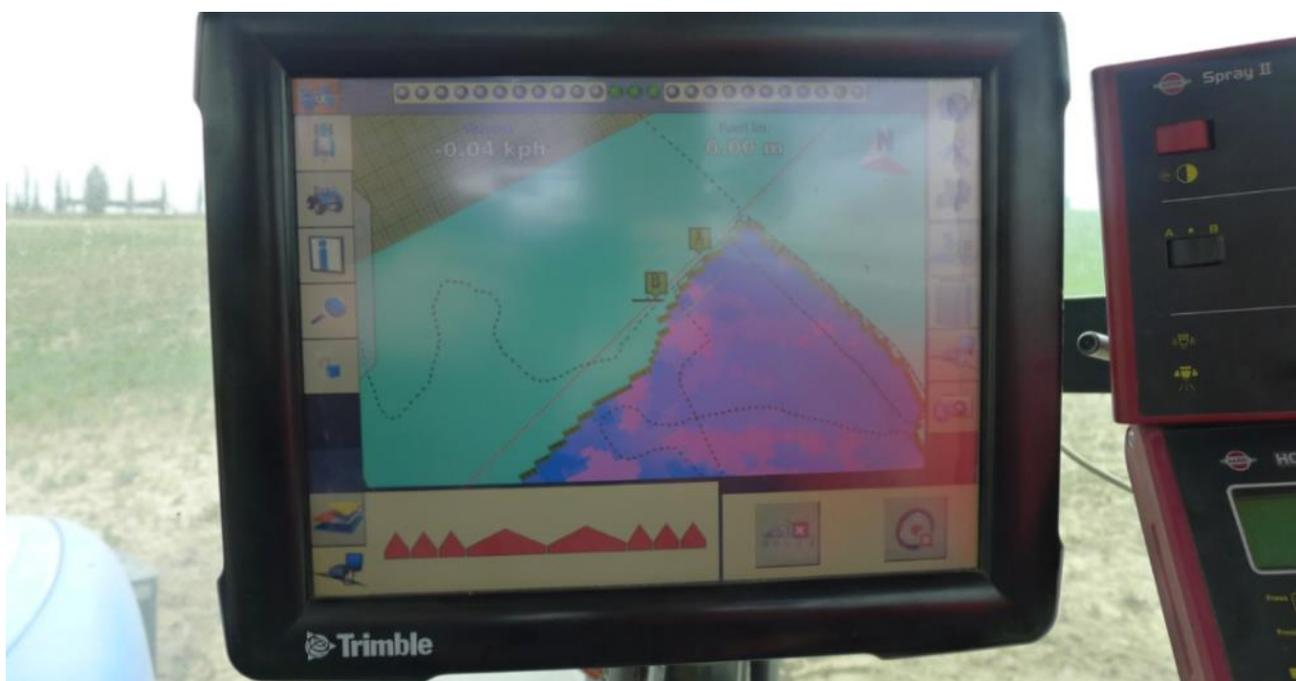
Figura 13- Mappa riclassata in Siti4farmer, esportata in formato shapefile ed inserita all'interno del modulo Trimble in dotazione presso l'Azienda Agricola Baccoleno
