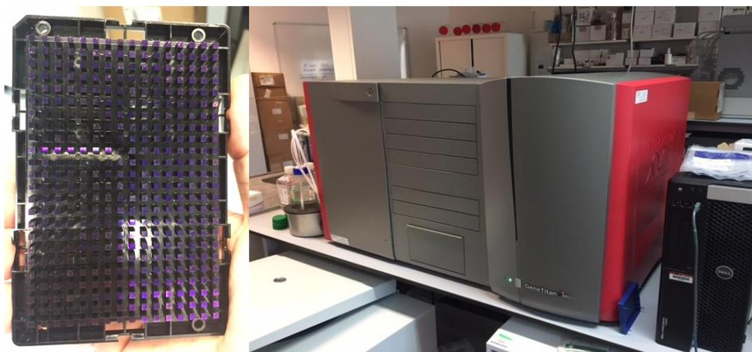
Fig. 6.2 Wheat breed Axiom array da 35k e piattaforma Gene Titan per la lettura dell'Array.
