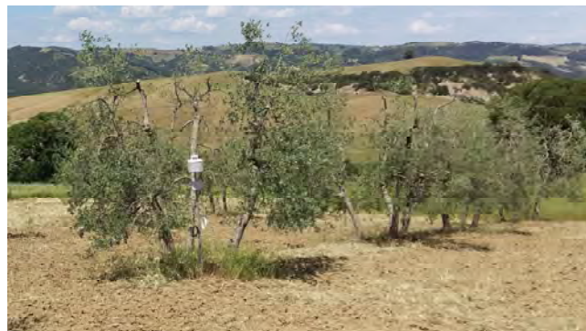
Figura 2: Monitoraggio della temperatura dell'aria nei pressi di un olivo Figure:2 Field measurement of air temperature near an olive tree
