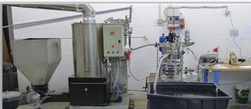
Una seconda soluzione si è basata su un sistema con caldaia a cippatino, scambiatore/espansore, turbina ad aria. Entrambe le soluzioni sono caratterizzate da limitata potenza termica (100-300 kWt) ed elettrica (5-30 kWe).
